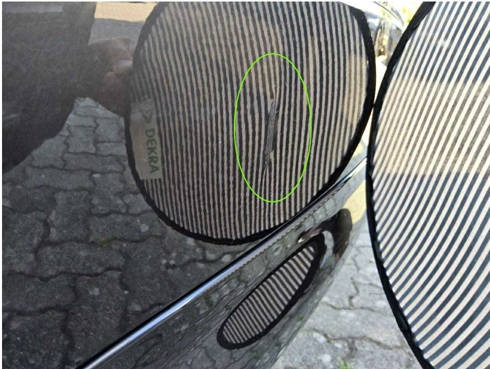
Bild 15 : Stoßfänger hinten deformiert und verschrammt, Diffusor Schramme
