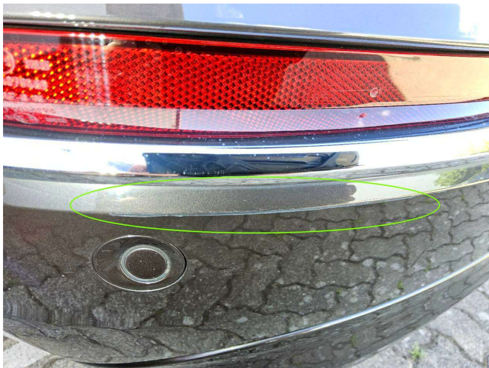
Bild 12 : Stoßfänger hinten deformiert und verschrammt, Diffusor Schramme
