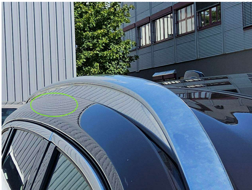
Bild 11 : Dachholm rechts Delle
