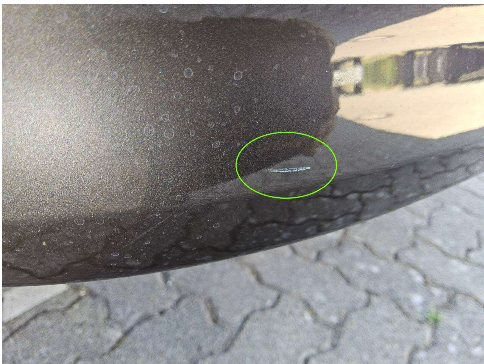
Bild 14 : Stoßfänger hinten deformiert und verschrammt, Diffusor Schramme
