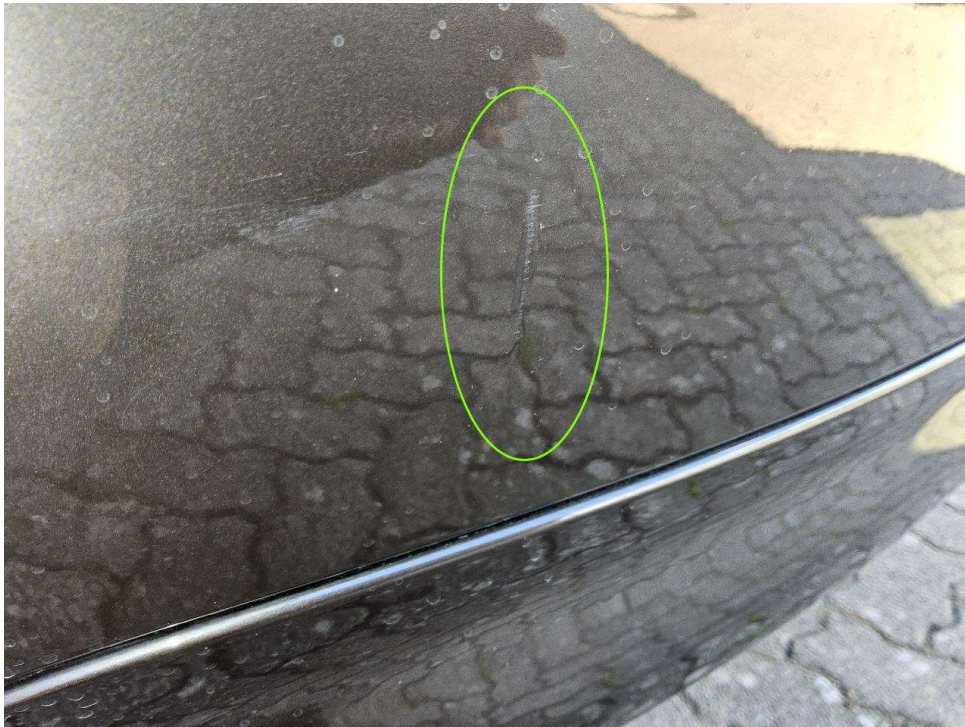
Bild 13 : Stoßfänger hinten deformiert und verschrammt, Diffusor Schramme
