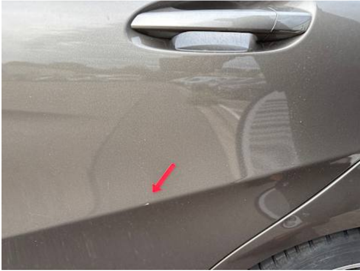
Türe hinten links (Lackschaden)
