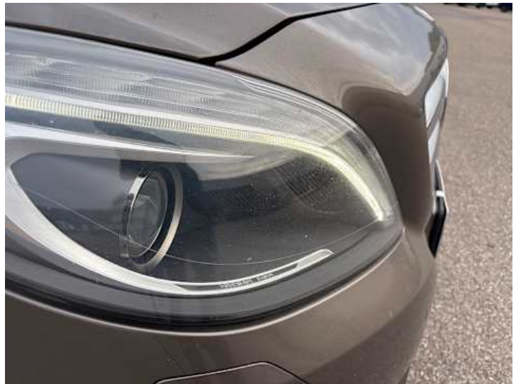
Scheinwerfer (rechts) (Steinschlag)
