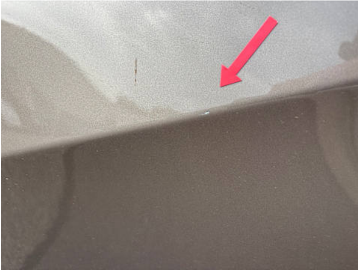
Türe hinten links (Lackschaden)
