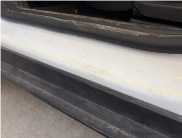
Schweller links (Kratzer)
