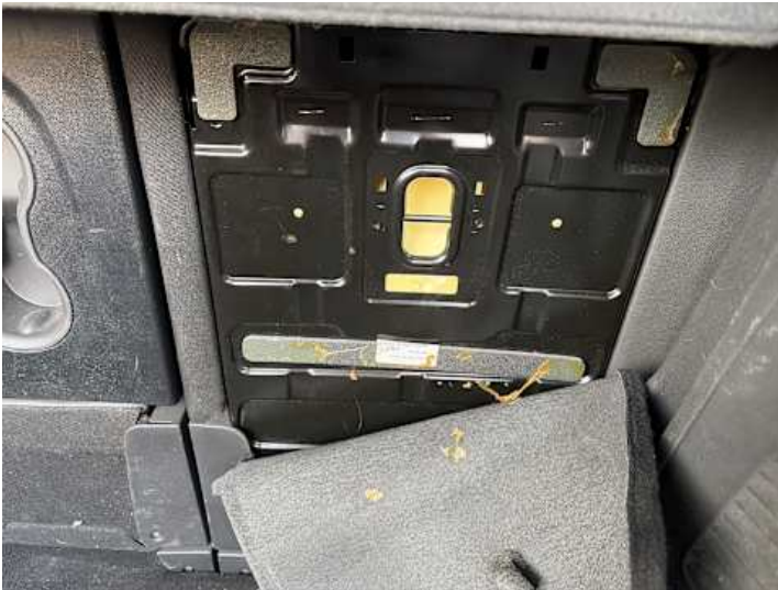
Innenraum (Anderer Schaden): Abdeckung nicht befestigt
