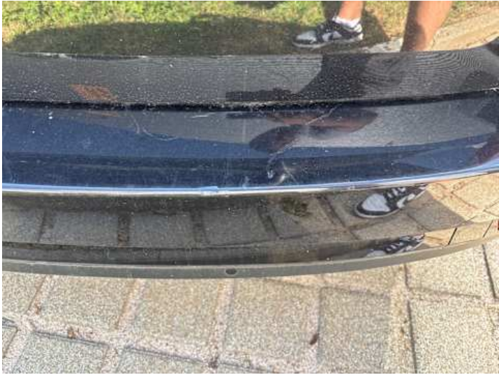
Stoßstange hinten (Kratzer, Lackschaden)
