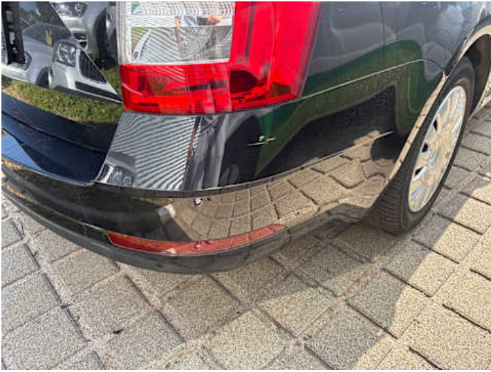
Stoßstange hinten (Kratzer, Lackschaden)
