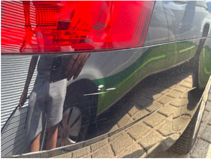
Stoßstange hinten (Kratzer, Lackschaden)
