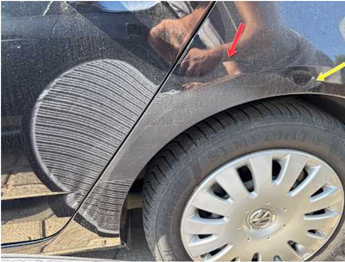
Seitenteil hinten links (Kratzer, Lackschaden, Unsachgemäß instand gesetzt)
