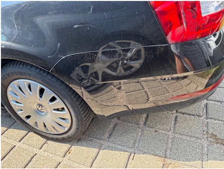
Stoßstange hinten (Kratzer, Lackschaden)
