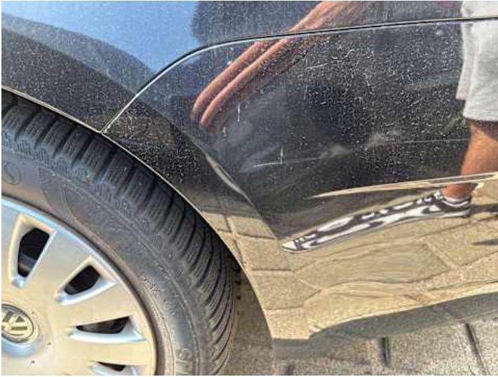
Stoßstange hinten (Kratzer, Lackschaden)
