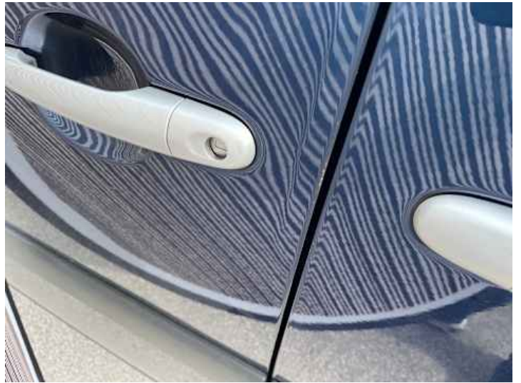
Fahrtür (Delle, Kratzer)
