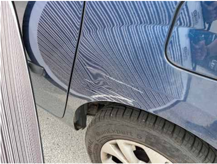
Seitenteil hinten links (Verformung, Kratzer)
