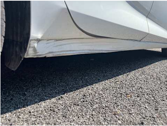
Schweller rechts (Lackschaden, Verformung)
