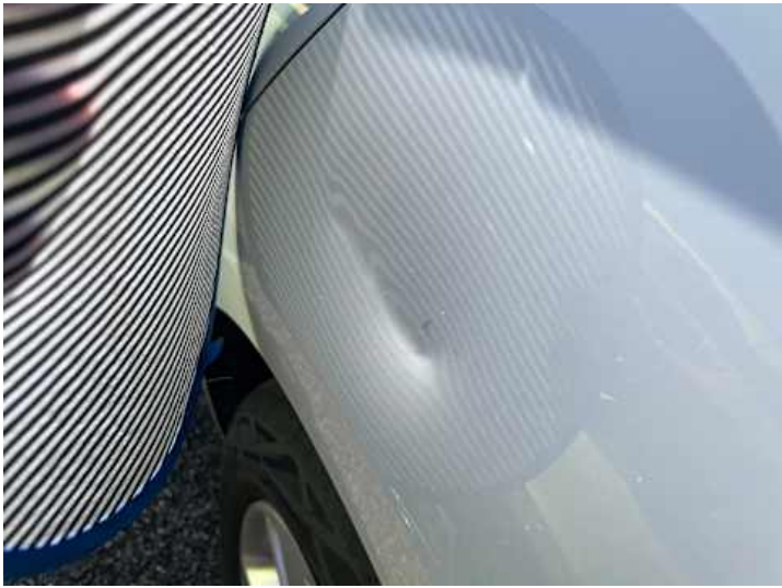
Seitenteil hinten links (Lackschaden, Delle)
