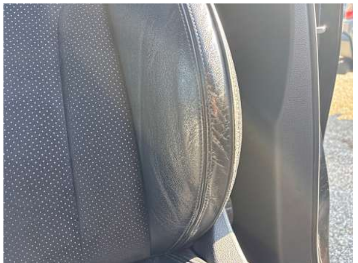
Innenraum (Verschleiß, Riss/Bruch)
