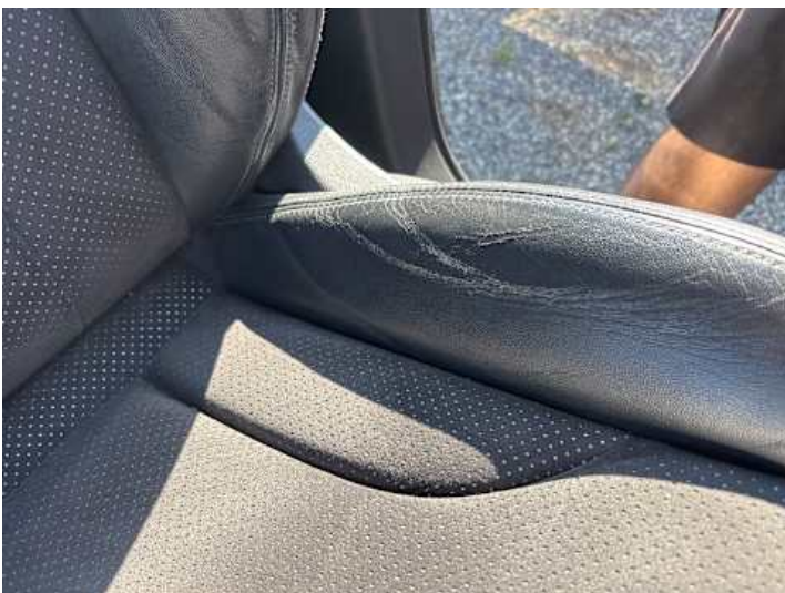
Innenraum (Verschleiß, Riss/Bruch)
