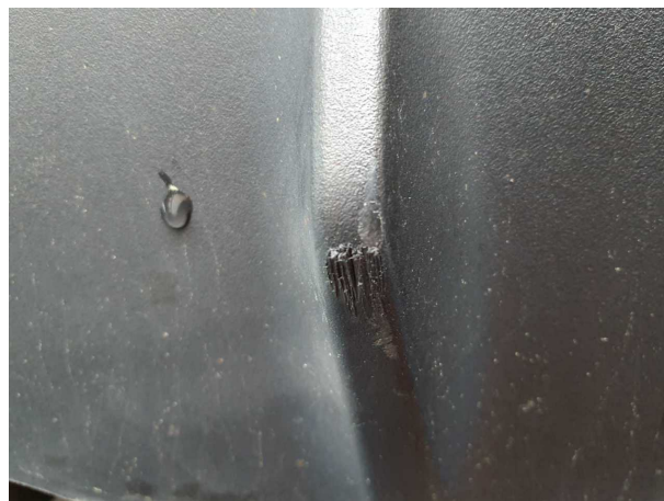
Beschädigung 6: Stossfänger hinten: Spoiler - verkratzt / verschürft - Wertminderung
