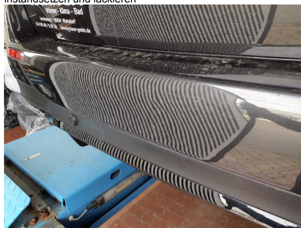
Beschädigung 16: Stossfänger hinten: Stossfänger hinten - Delle / Lackschaden - instandsetzen und lackieren
