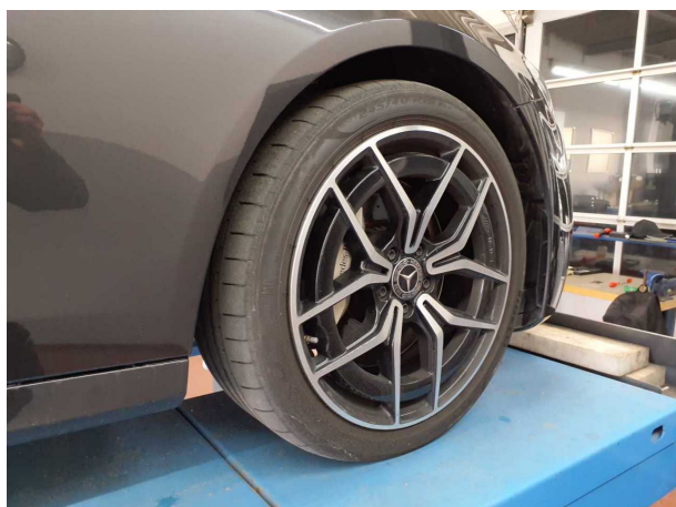
Beschädigung 11: Rad/Reifen: Reifen vorn - verschlissen - erneuern
