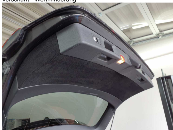
Beschädigung 7: Verkleidungen/Abdeckungen: Heckdeckel, Innenverkleidung (Fehlstellung) - verkratzt / verschürft -
