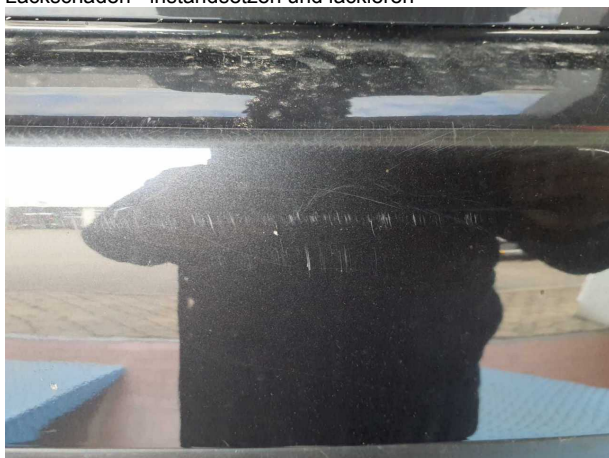
Beschädigung 16: Stossfänger hinten: Stossfänger hinten - Dell... Lackschaden - instandsetzen und lackieren
