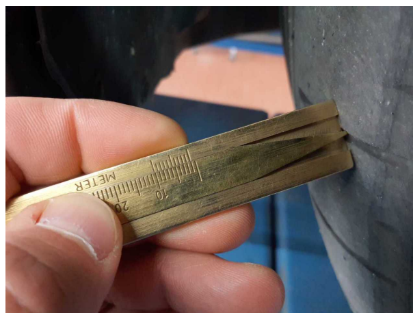
Beschädigung 11: Rad/Reifen: Reifen vorn - verschlissen - erneuern
