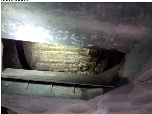
Beschädigung 9: Getriebe: Verteilergetriebe - undicht - Diagnose durchführen
