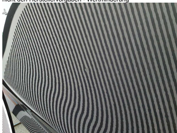
Beschädigung 15: Tür vorn rechts: Tür - Delle / Lackschaden - instandsetzen und lackieren
