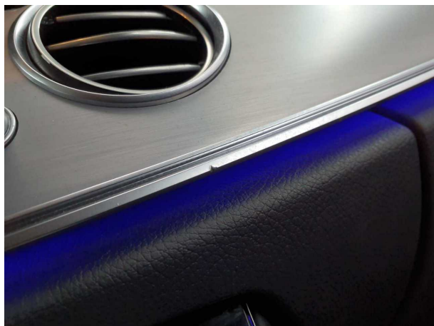
Beschädigung 12: Instrumententafel: Blende - verkratzt / verschürft - erneuern
