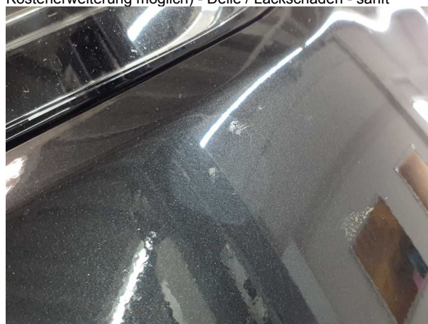
Beschädigung 5: Stossfänger vorn: Stossfänger vorn (Ggf Kostenerweiterung möglich) - Lackmangel - aufbereiten
