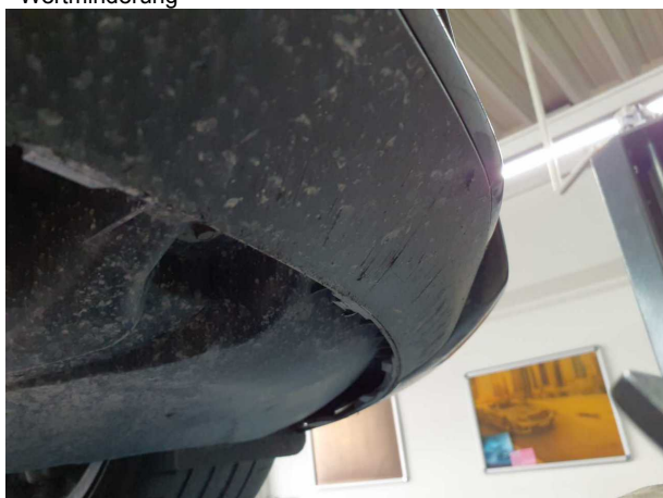
Beschädigung 3: Stossfänger vorn: Spoiler - verkratzt / verschürft - Wertminderung
