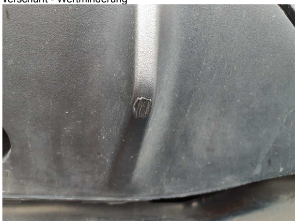
Beschädigung 6: Stossfänger hinten: Spoiler - verkratzt / verschürft - Wertminderung
