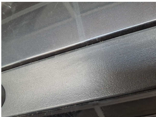
Beschädigung 6: Stossfänger hinten: Spoiler - verkratzt / verschürft - Wertminderung
