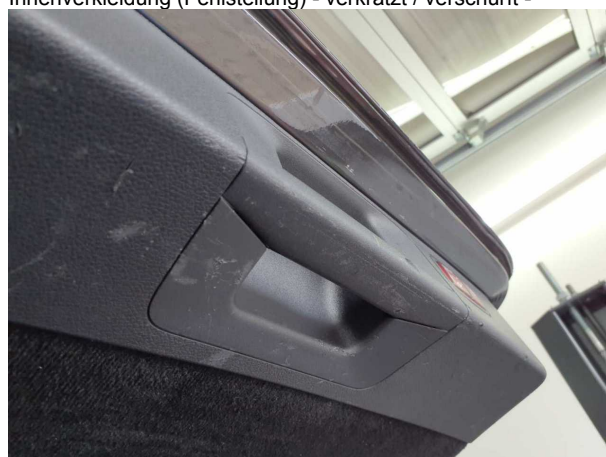
Beschädigung 7: Verkleidungen/Abdeckungen: Heckdeckel, Innenverkleidung (Fehlstellung) - verkratzt / verschürft -
