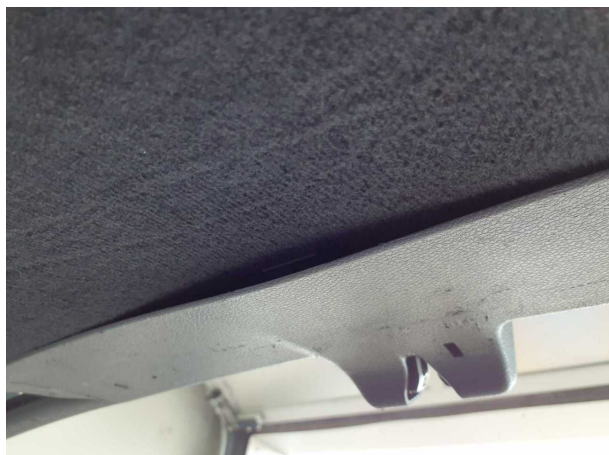
Beschädigung 7: Verkleidungen/Abdeckungen: Heckdeckel, Innenverkleidung (Fehlstellung) - verkratzt / verschürft -
