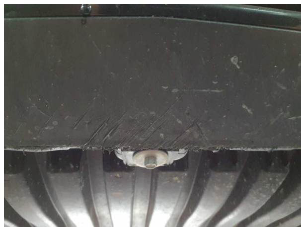
Beschädigung 3: Stossfänger vorn: Spoiler - verkratzt / verschürft - Wertminderung
