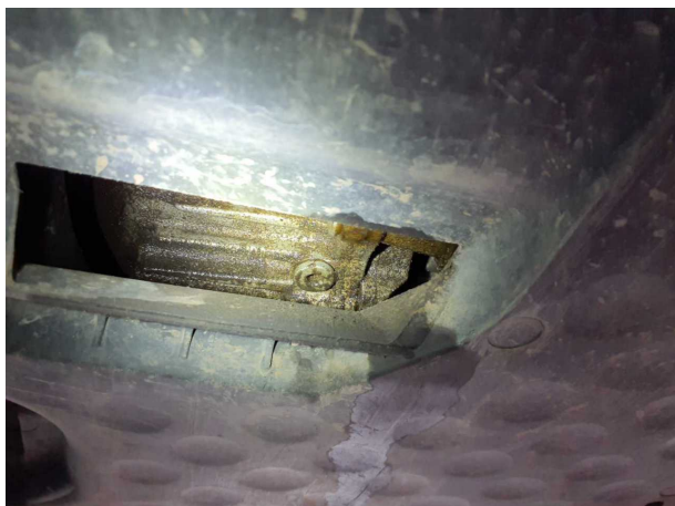
Beschädigung 9: Getriebe: Verteilergetriebe - undicht - Diagnose durchführen
