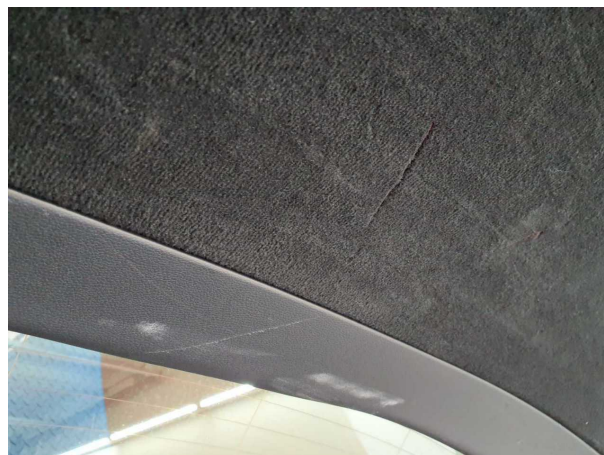
Beschädigung 7: Verkleidungen/Abdeckungen: Heckdeckel, Innenverkleidung (Fehlstellung) - verkratzt / verschürft -
