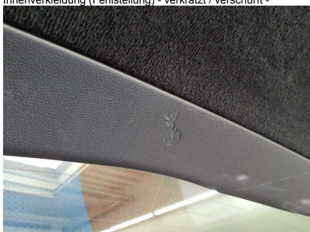
Beschädigung 7: Verkleidungen/Abdeckungen: Heckdeckel, Innenverkleidung (Fehlstellung) - verkratzt / verschürft -
