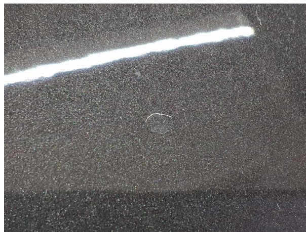
Beschädigung 4: Seitenwand links: Seitenwand (Ggf Kostenerweiterung möglich) - Delle / Lackschaden - sanft
