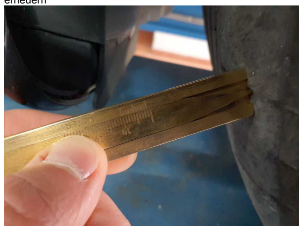
Beschädigung 11: Rad/Reifen: Reifen vorn - verschlissen - erneuern
