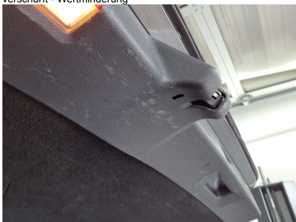
Beschädigung 7: Verkleidungen/Abdeckungen: Heckdeckel, Innenverkleidung (Fehlstellung) - verkratzt / verschürft -
