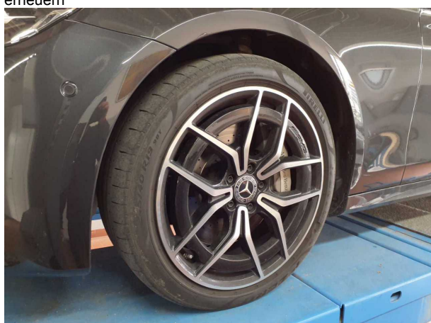
Beschädigung 11: Rad/Reifen: Reifen vorn - verschlissen - erneuern
