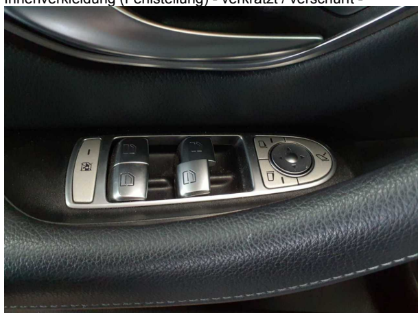
Beschädigung 8: Tür vorn links: Fensterheber (Taster für Beifahrerseite) - defekt - erneuern
