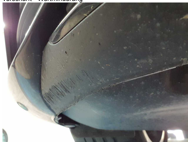
Beschädigung 3: Stossfänger vorn: Spoiler - verkratzt / verschürft - Wertminderung
