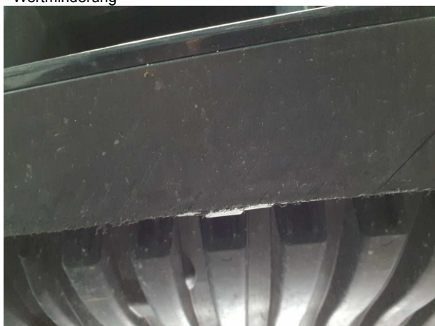
Beschädigung 3: Stossfänger vorn: Spoiler - verkratzt / verschürft - Wertminderung
