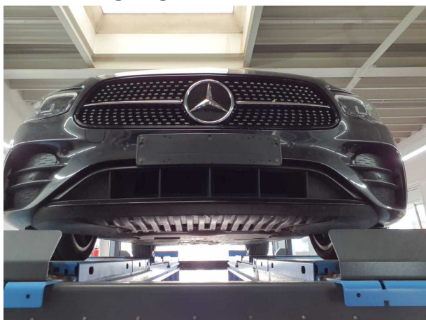
Beschädigung 3: Stossfänger vorn: Spoiler - verkratzt / verschürft - Wertminderung
