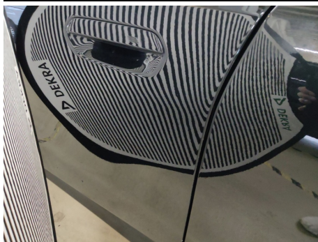
Tür / Vorne Links / Delle
