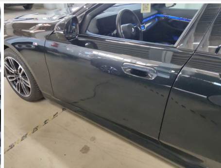
Tür / Vorne Links / Delle
