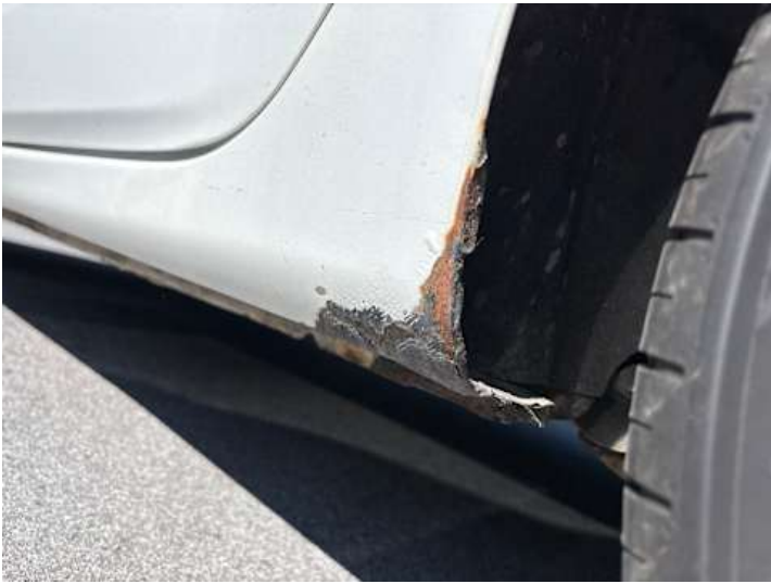
Schweller links (Rost)
