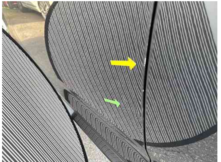
Fahrrertür (Delle, Lackschaden)
