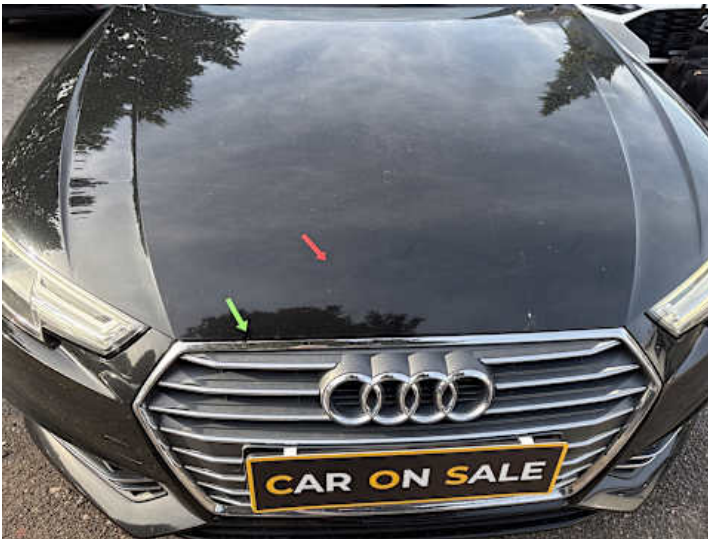
Motorhaube (Rost, Steinschlag)
