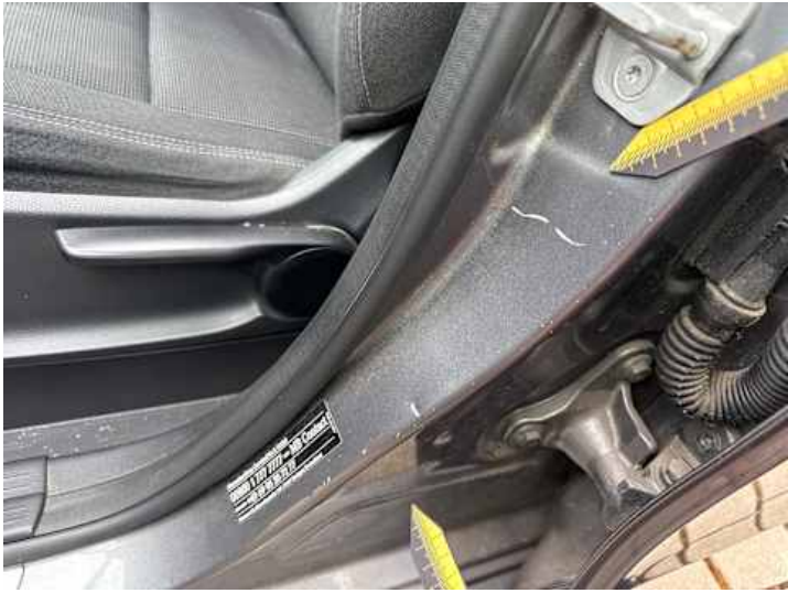
Schweller links (Kratzer, Delle)
