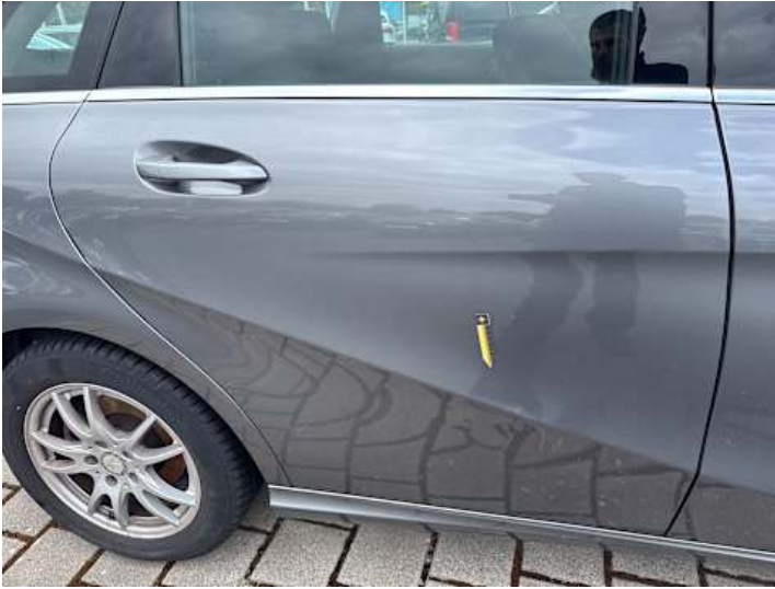
Türe hinten rechts (Verformung, Lackschaden)
