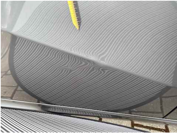
Türe hinten rechts (Verformung, Lackschaden)
