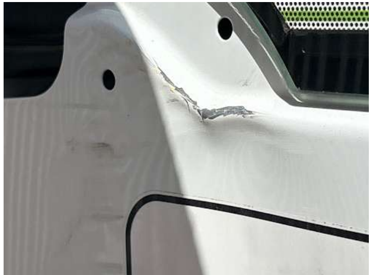
Türe hinten rechts (Kratzer, Verformung)
