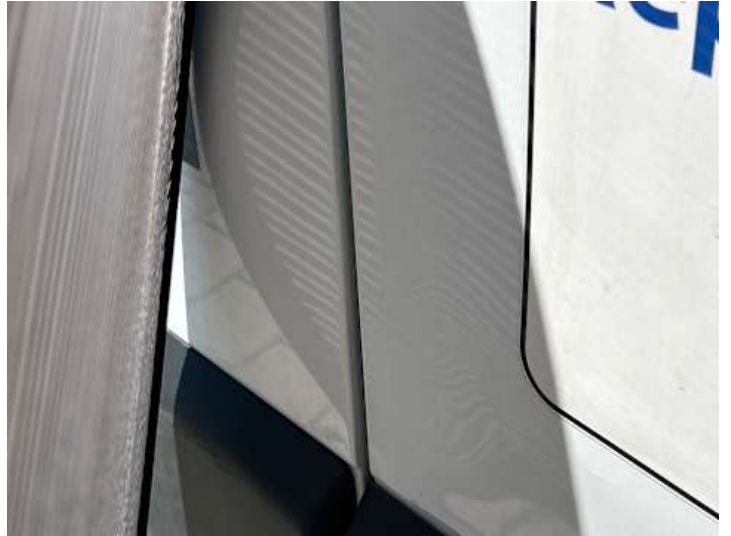
Türe hinten rechts (Kratzer, Verformung)
