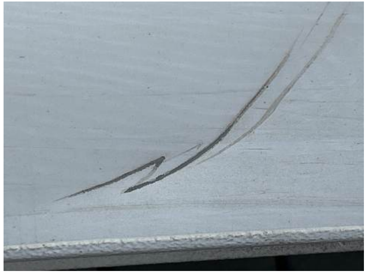
Türe hinten links (Verformung, Kratzer)
