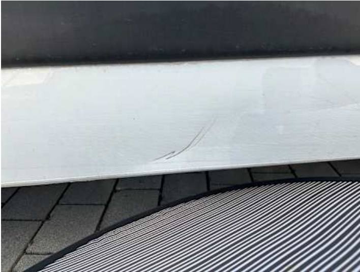
Türe hinten links (Verformung, Kratzer)
