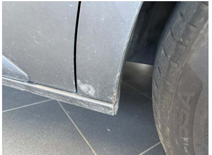
Kotflügel vorne rechts (Rost)
