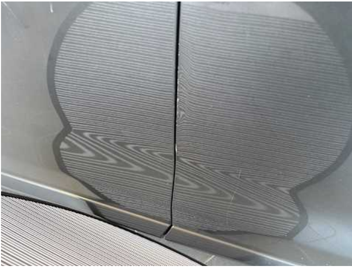
Beifahrertür (Kratzer, Verformung)
