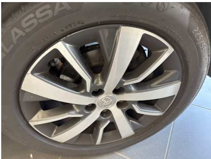
Rad (Kratzer, Ungleichmäßig abgefahren)
