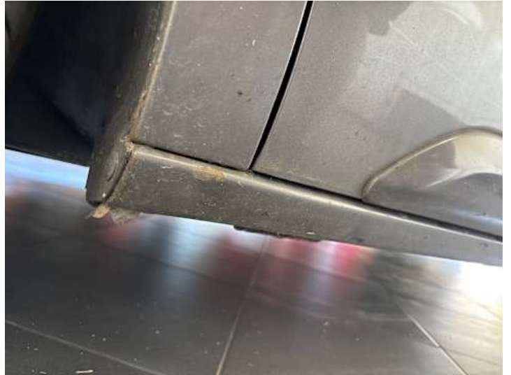
Schweller links (Rost)
