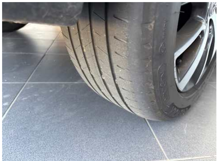
Rad (Ungleichmäßig abgefahren)
