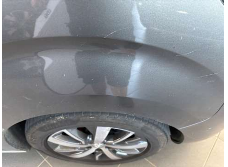
Kotflügel vorne rechts (Kratzer)
