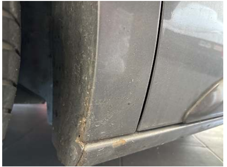
Kotflügel vorne links (Rost)
