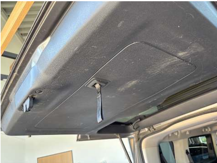
Innenraum (Verschmutzung, Verschleiß)
