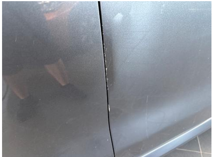
Beifahrtür (Kratzer, Verformung)
