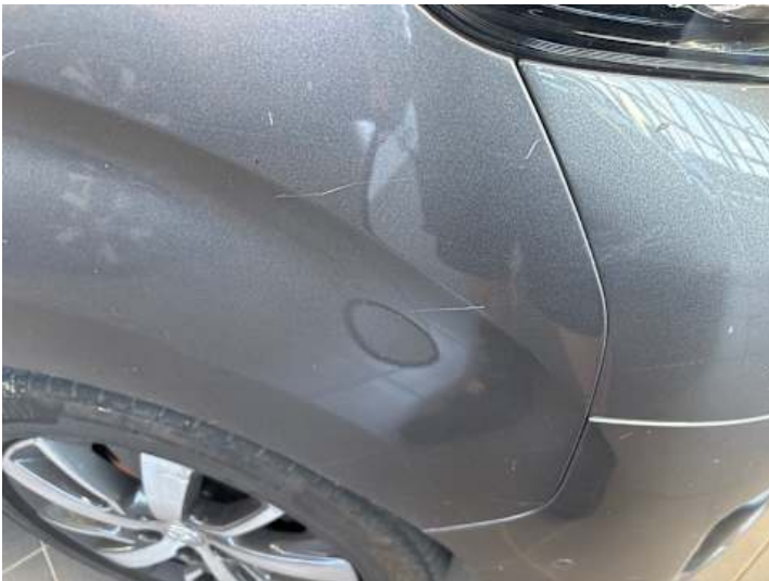
Kotflügel vorne rechts (Kratzer)
