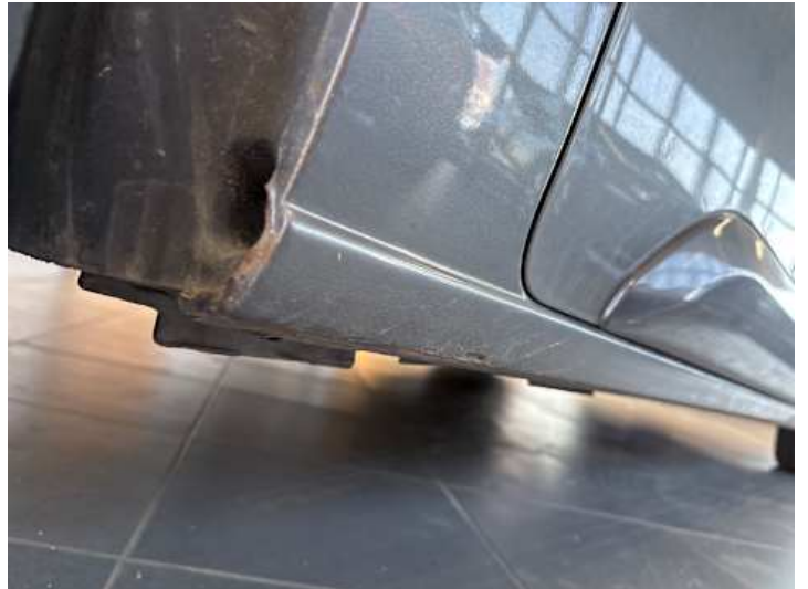
Schweller rechts (Rost)
