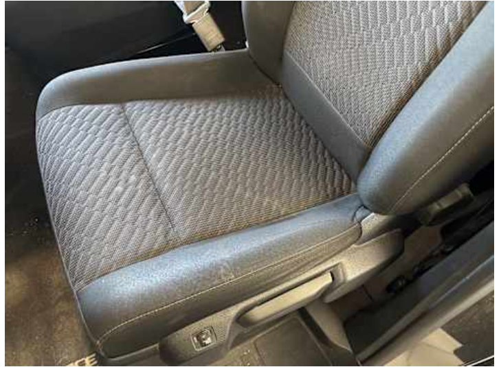
Innenraum (Verschmutzung, Verschleiß)
