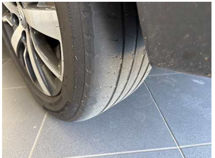
Rad (Kratzer, Ungleichmäßig abgefahren)
