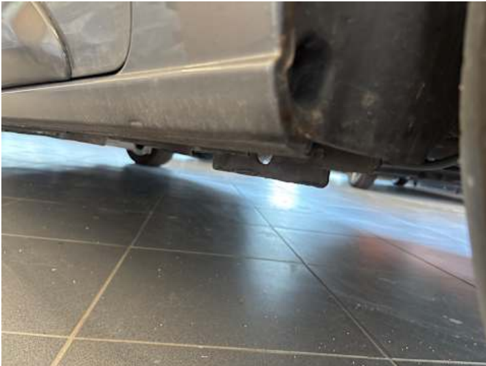
Schweller links (Rost)
