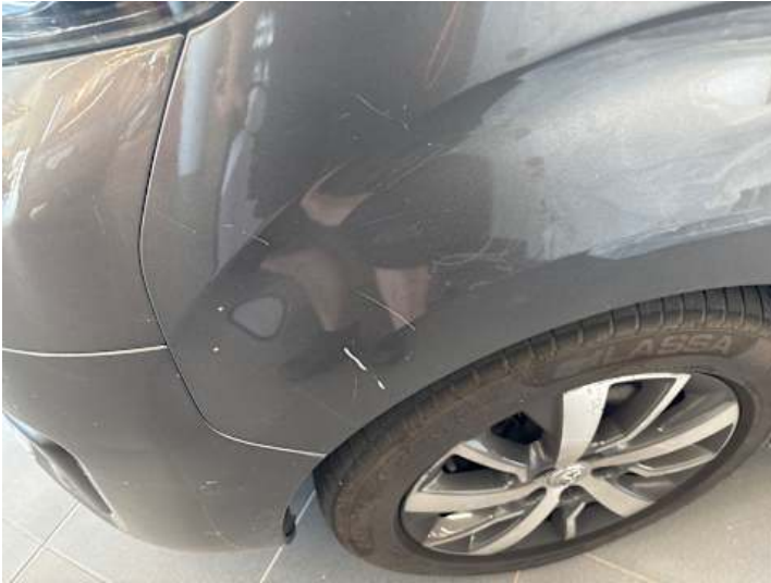
Kotflügel vorne links (Kratzer)
