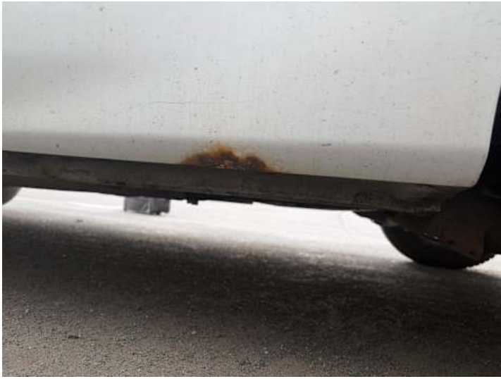
Schweller links (Lackschaden, Kratzer, Rost, Verformung)
