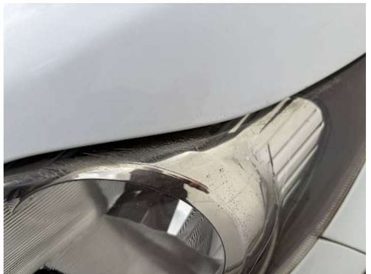
Scheinwerfer (links) (Kratzer, Riss/Bruch)
