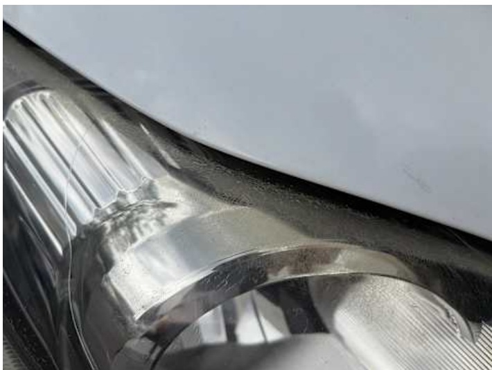
Scheinwerfer (rechts) (Kratzer, Riss/Bruch)
