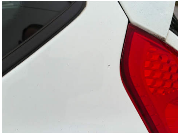
Seitenteil hinten links (Lackschaden, Kratzer)
