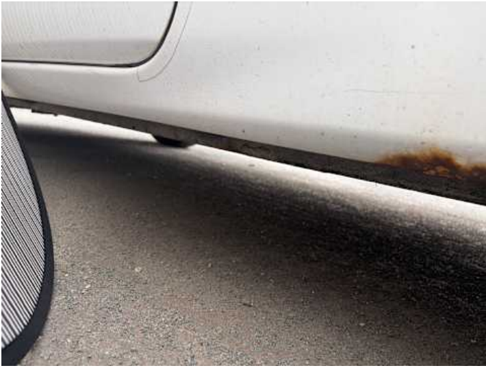
Schweller links (Lackschaden, Kratzer, Rost, Verformung)
