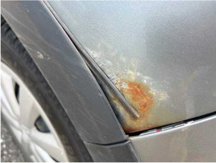
Seitenteil hinten links (Rost)
