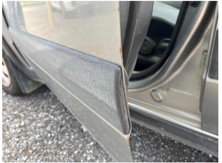
Fahrrertür (Lackschaden, Kratzer, Rost)
