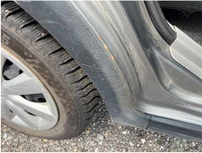
Seitenteil hinten rechts (Rost)
