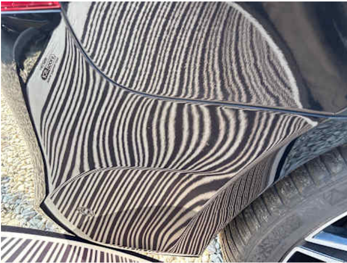
Stoßstange hinten (Lackschaden, Unsachgemäß instand gesetzt, Verformung)
