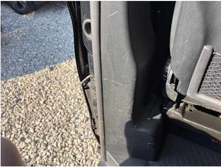
Innenraum (Verschmutzung, Kratzer)
