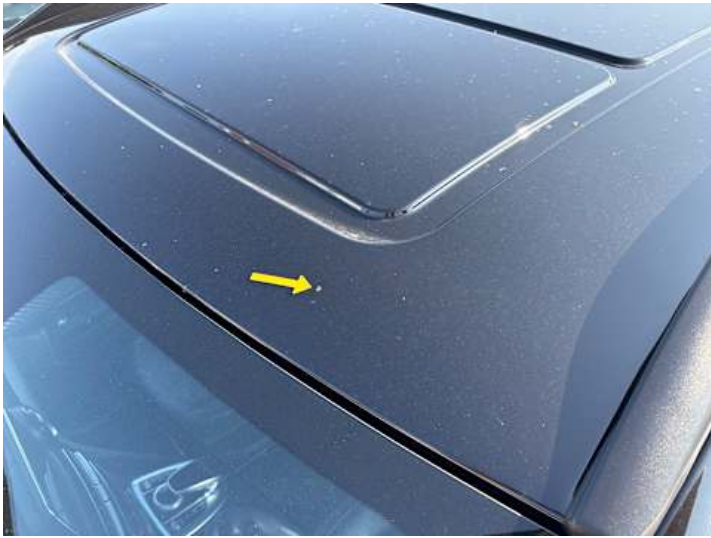
Dach (Lackschaden, Rost)
