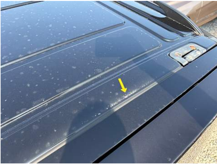
Dach (Lackschaden, Ausgeblichen/Matt)
