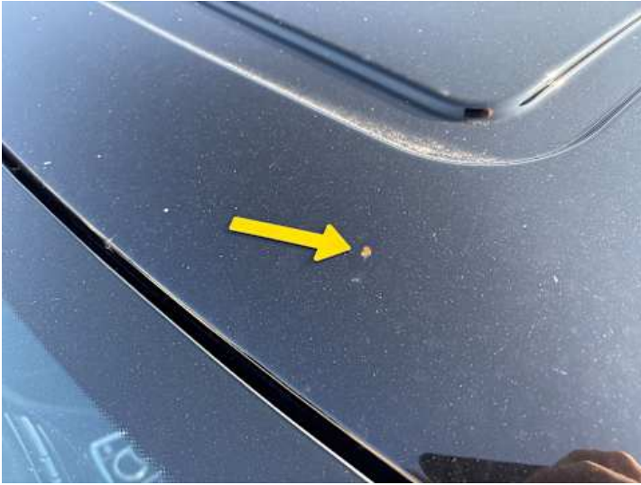
Dach (Lackschaden, Rost)
