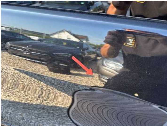
Türe hinten rechts (Unsachgemäß instand gesetzt, Lackschaden)
