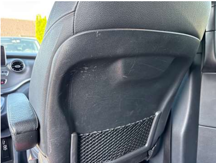
Innenraum (Verschmutzung, Kratzer)
