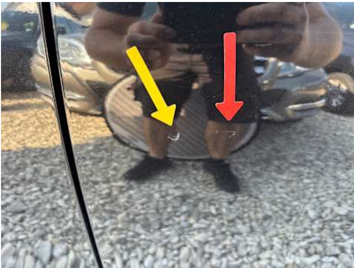
Beifahrtür (Kratzer, Lackschaden)
