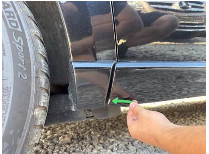
Türe hinten rechts (Kratzer, Lackschaden, Delle, Unsachgemäß instand gesetzt)
