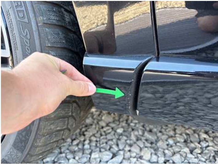
Schweller rechts (Kratzer, Lackschaden)
