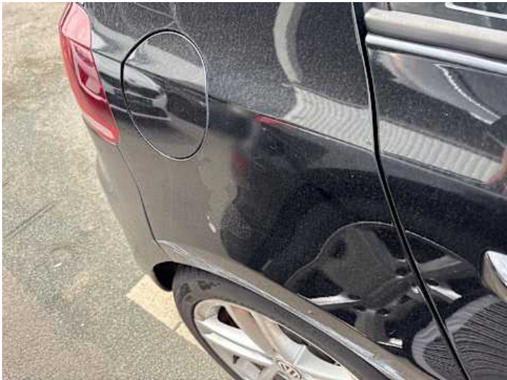
Seitenteil hinten rechts (Lackschaden)
