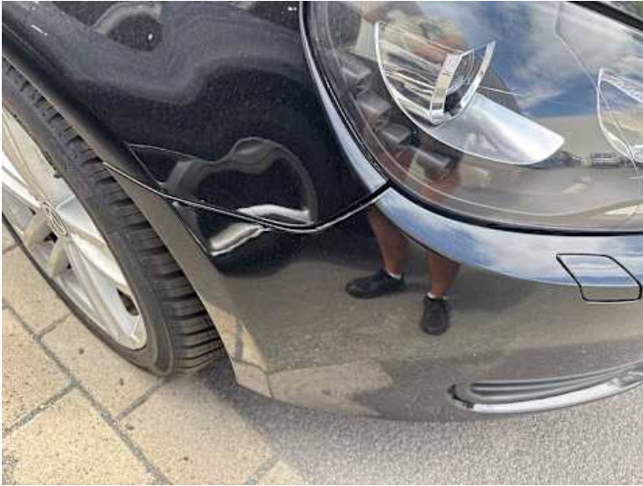
Stoßstange vorne (Spaltmaße ungenau)
