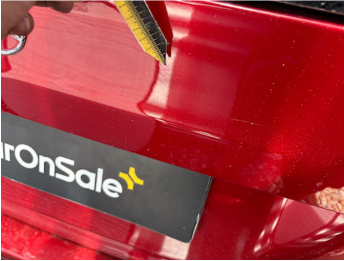
Heckklappe (Lackschaden, Kratzer)
