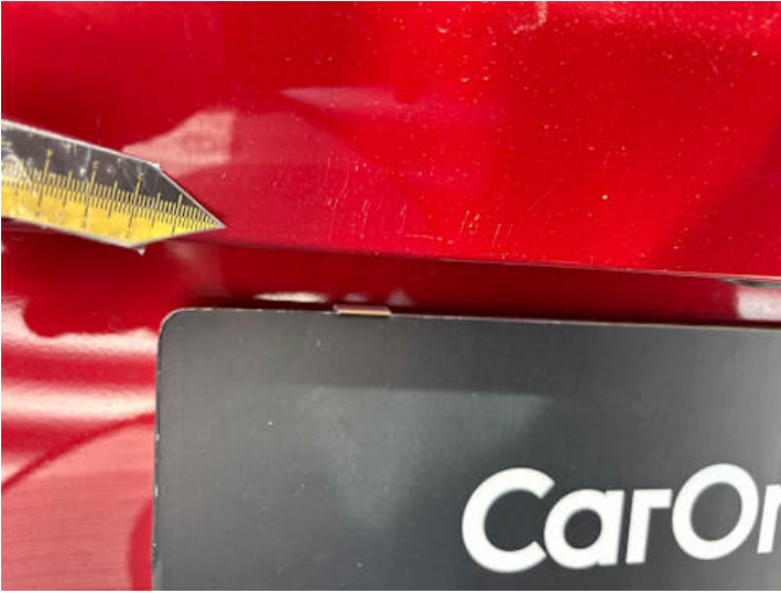
Heckklappe (Lackschaden, Kratzer)
