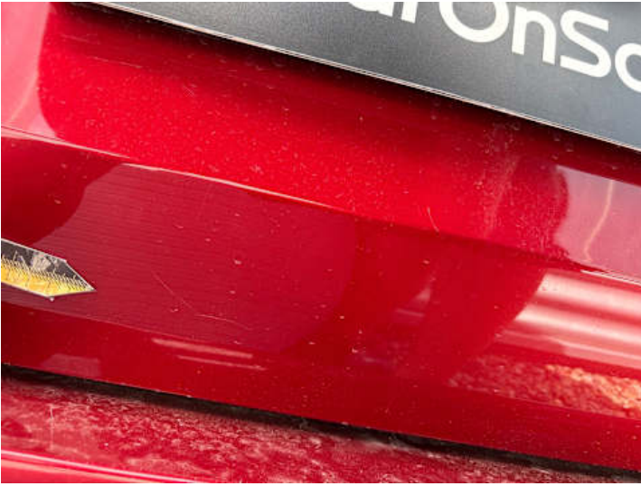
Heckklappe (Lackschaden, Kratzer)
