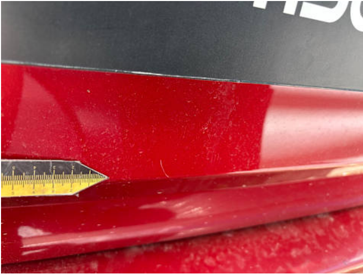
Heckklappe (Lackschaden, Kratzer)
