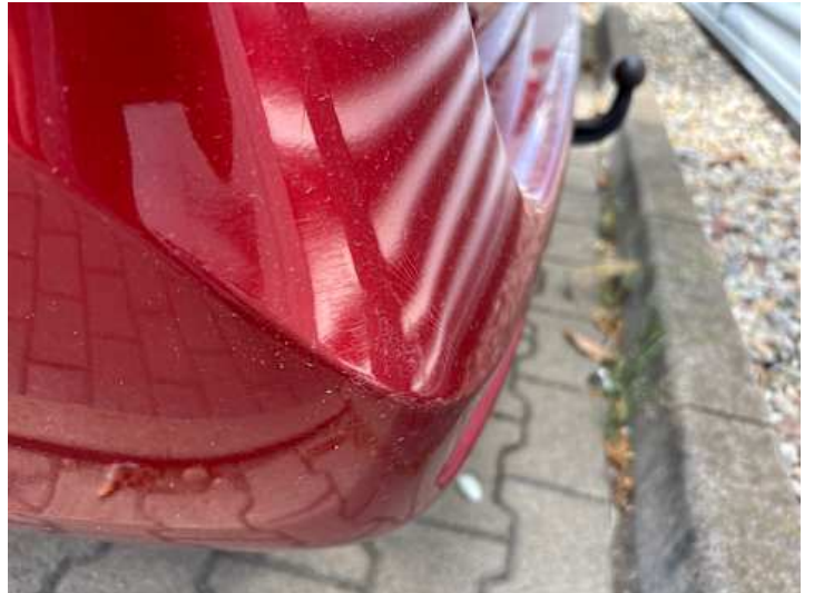
Stoßstange hinten (Riss/Bruch, Lackschaden)
