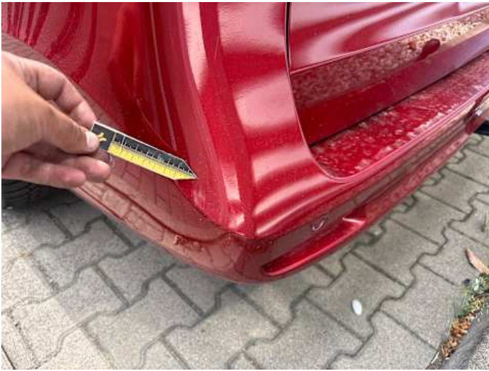
Stoßstange hinten (Riss/Bruch, Lackschaden)
