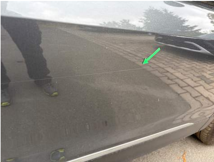
Beifahrertür (Delle, Kratzer)
