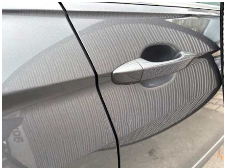
Beifahrertür (Delle, Kratzer)
