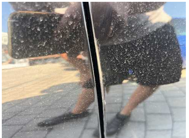
Beifahrertür (Lackschaden, Unsachgemäß instand gesetzt)
