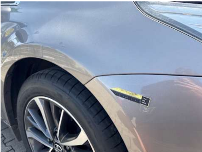
Stoßstange vorne (Unsachgemäß instand gesetzt)
