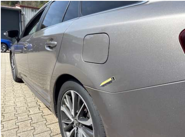
Stoßstange hinten (Spaltmaße ungenau, Lackschaden, Verformung)
