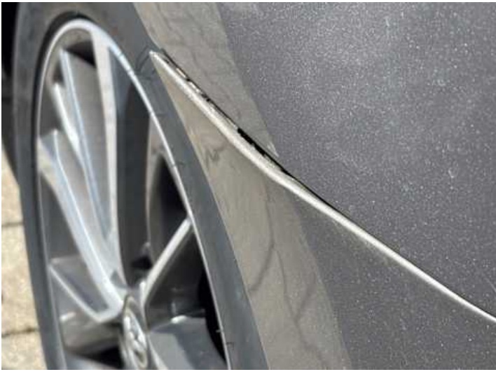
Stoßstange hinten (Spaltmaße ungenau, Lackschaden, Verformung)
