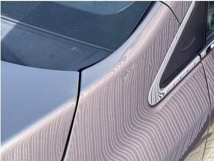
Kotflügel vorne links (Delle, Verformung)
