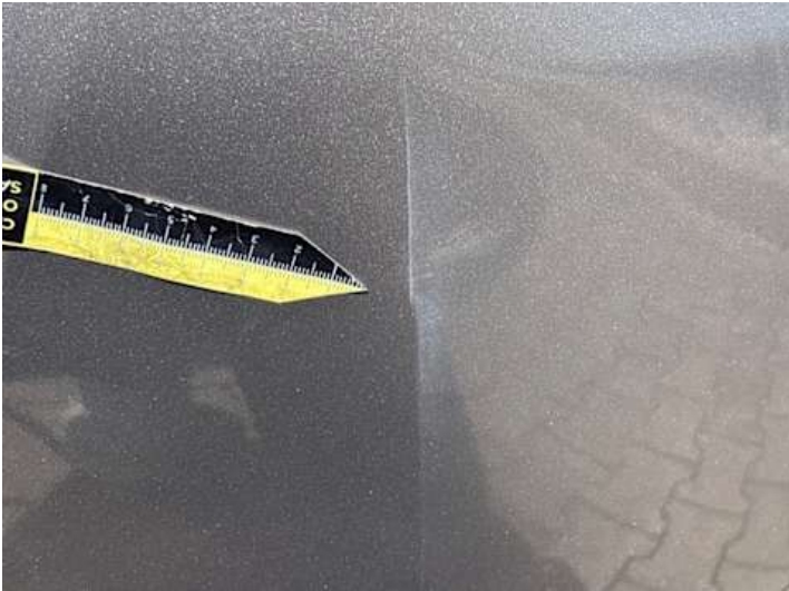
Stoßstange hinten (Kratzer, Lackschaden)
