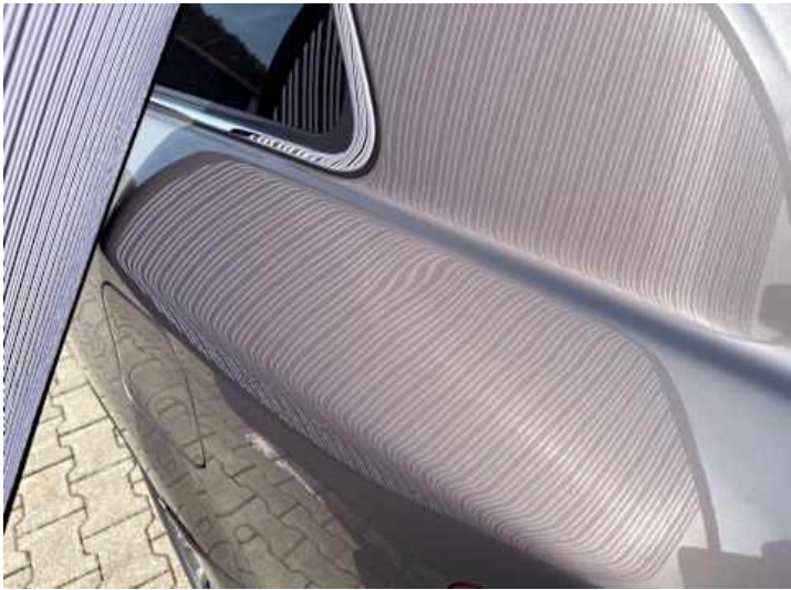
Seitenteil hinten links (Delle, Verformung)
