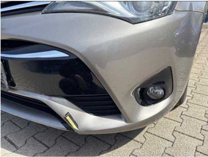
Stoßstange vorne (Kratzer, Lackschaden)
