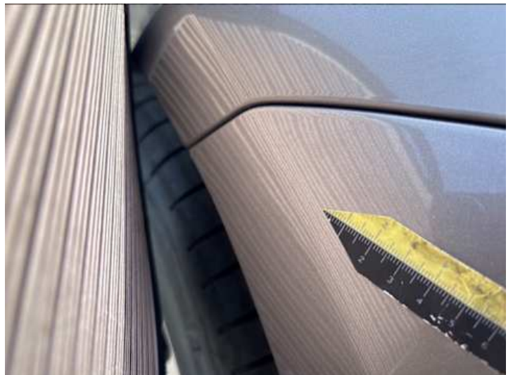
Stoßstange vorne (Unsachgemäß instand gesetzt)
