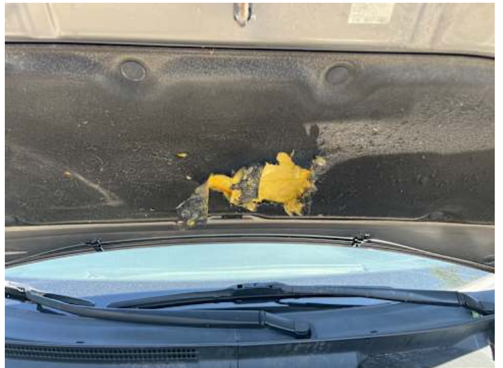
Motorhaube (Anderer Schaden): Dämmmatte defekt
