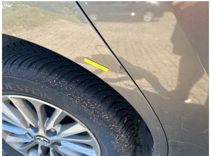
Seitenteil hinten rechts (Lackschaden)
