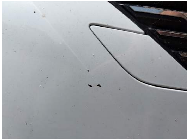
Stoßstange vorne (Kratzer, Lackschaden)
