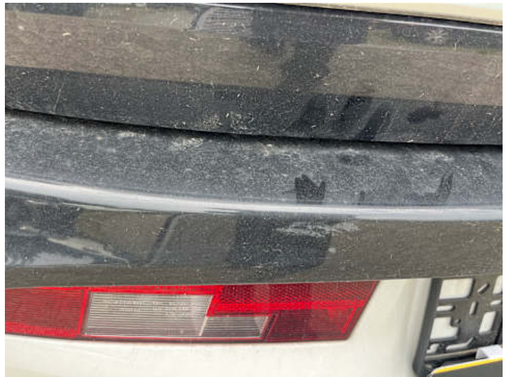
Stoßstange hinten (Kratzer, Lackschaden)
