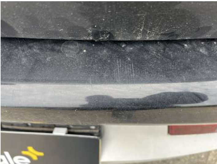
Stoßstange hinten (Kratzer, Lackschaden)
