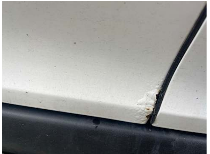
Türe hinten rechts (Lackschaden, Rost)
