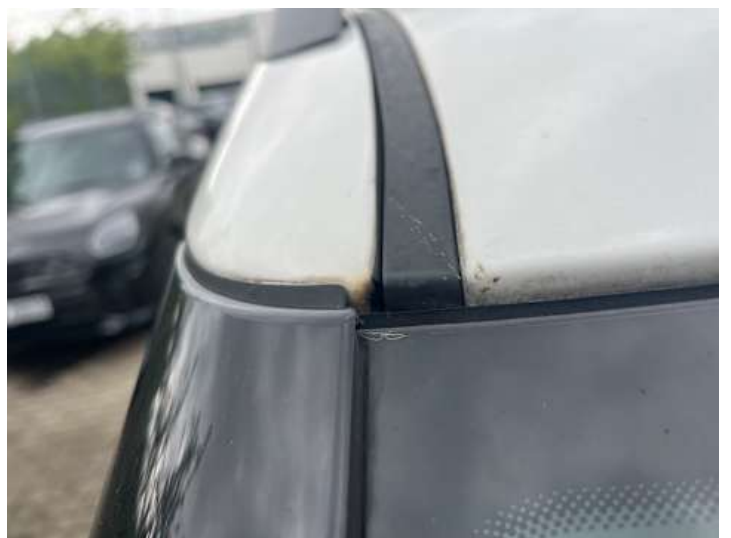
Seitenteil hinten rechts (Lackschaden, Rost)
