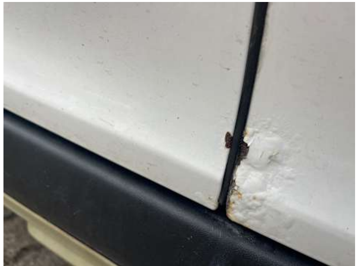
Fahrtür (Lackschaden, Rost)
