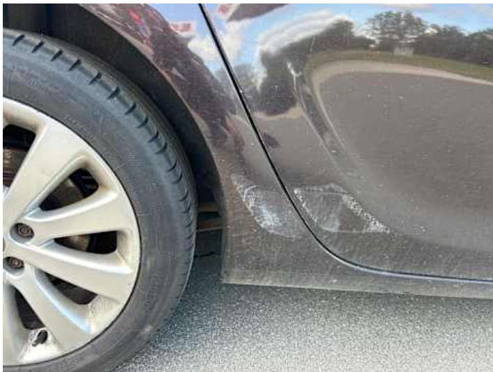
Seitenteil hinten rechts (Kratzer)
