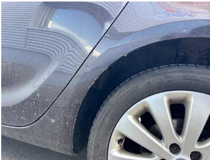
Seitenteil hinten links (Delle)
