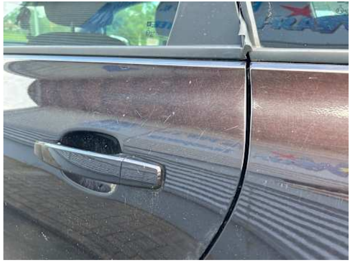
Türe hinten links (Kratzer, Riss/Bruch)
