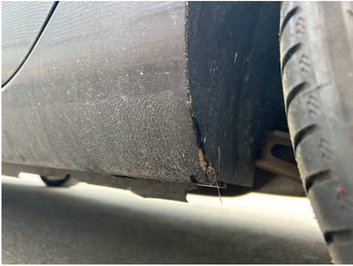
Schweller links (Rost)
