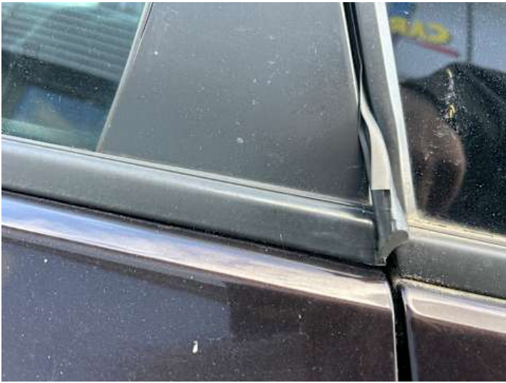
Türe hinten links (Kratzer, Riss/Bruch)
