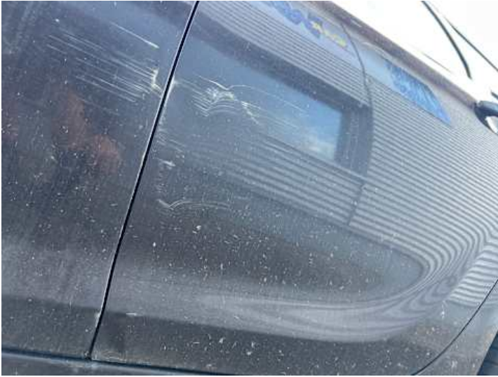
Türe hinten links (Delle, Kratzer, Lackschaden)
