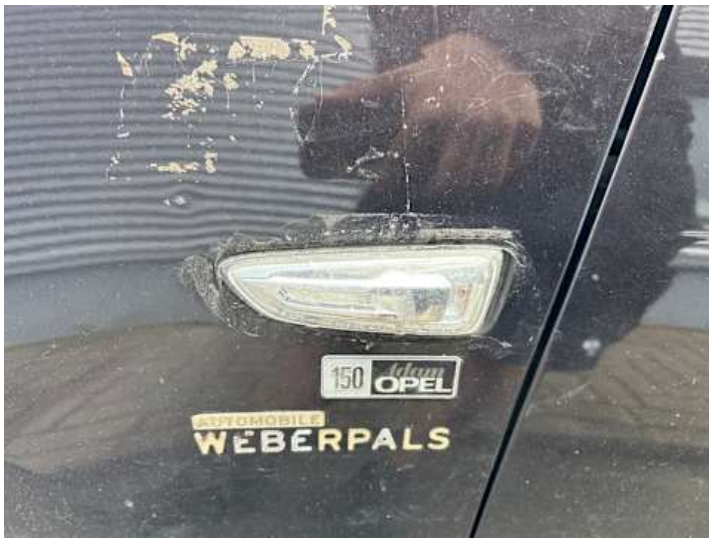
Kotflügel vorne links (Verformung, Delle, Unsachgemäß instand gesetzt)
