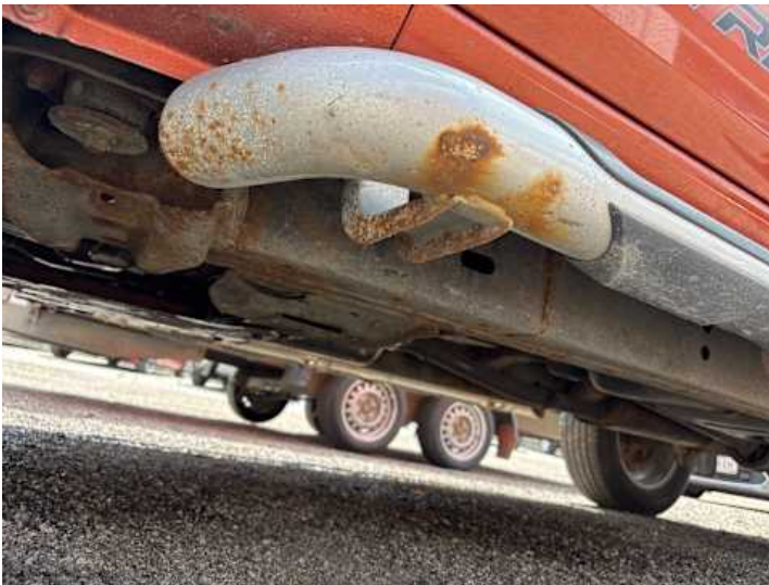
Schweller links (Rost)
