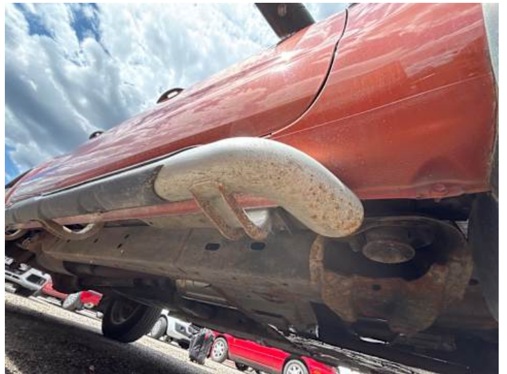
Schweller rechts (Rost)
