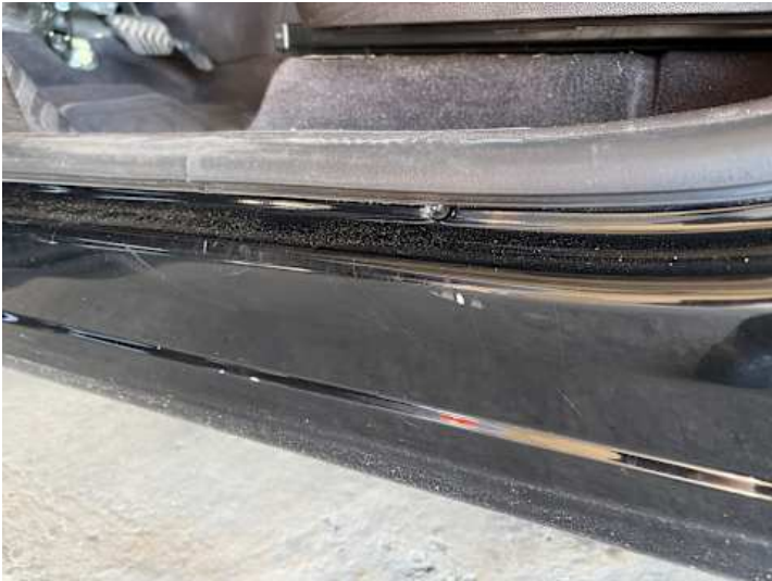
Schweller links (Kratzer)
