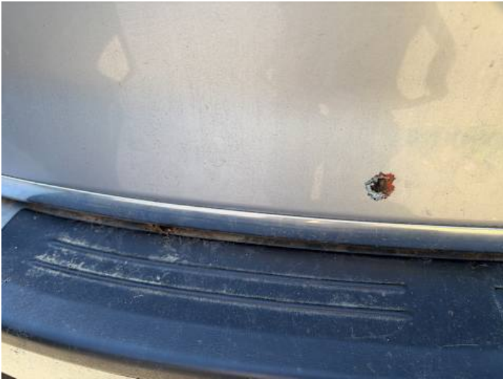
Heckklappe (Lackschaden, Kratzer)
