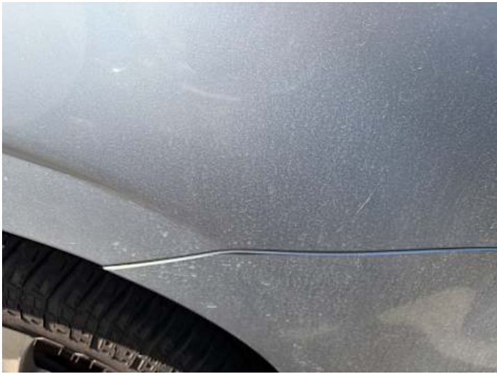
Seitenteil hinten links (Lackschaden, Kratzer)
