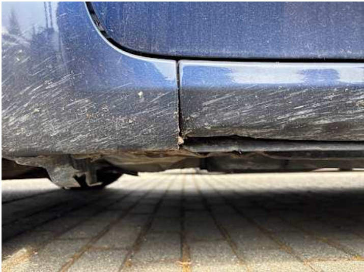
Schweller links (Verformung)
