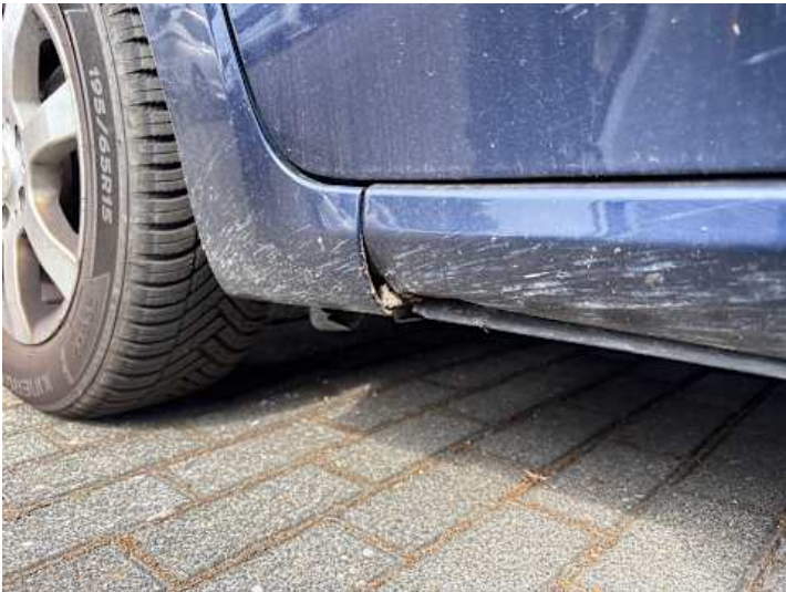
Schweller links (Verformung)
