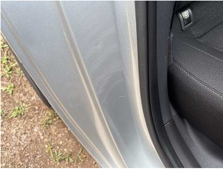
Schweller rechts (Delle)
