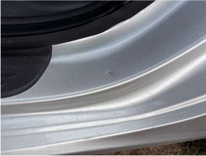
Schweller links (Lackschaden, Delle)
