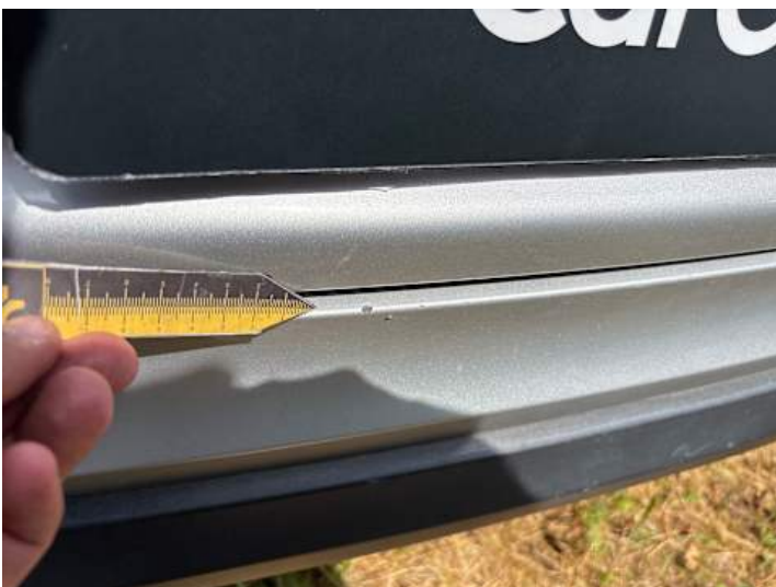
Stoßstange hinten (Lackschaden, Kratzer)
