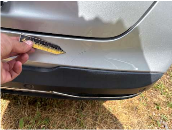
Stoßstange hinten (Lackschaden, Kratzer)
