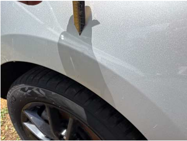
Seitenteil hinten rechts (Lackschaden, Delle)
