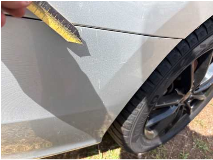
Stoßstange hinten (Lackschaden, Kratzer)
