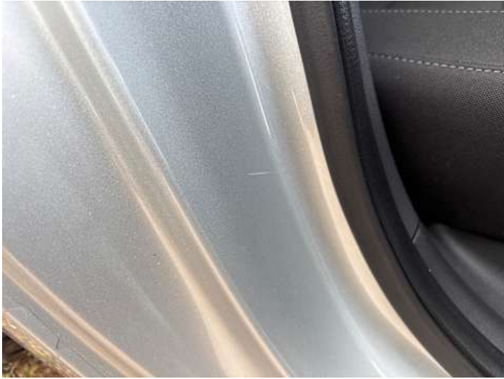
Schweller rechts (Lackschaden)
