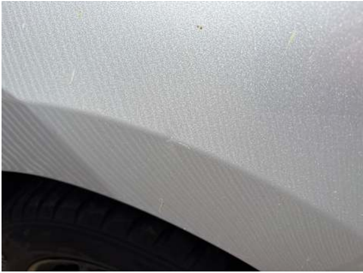
Seitenteil hinten rechts (Lackschaden, Delle)
