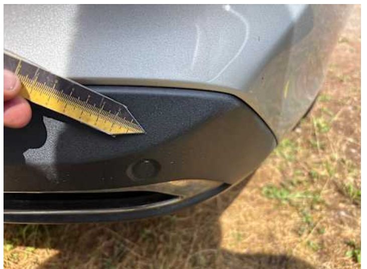
Stoßstange hinten (Lackschaden, Kratzer)
