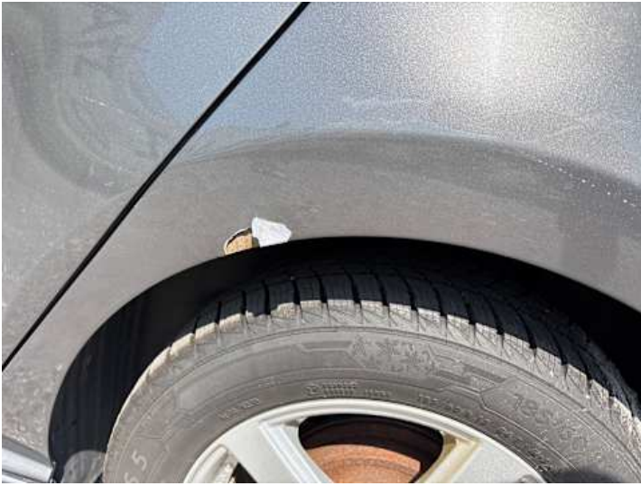
Seitenteil hinten links (Rost)
