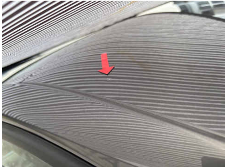
Dach (Delle, Lackschaden)
