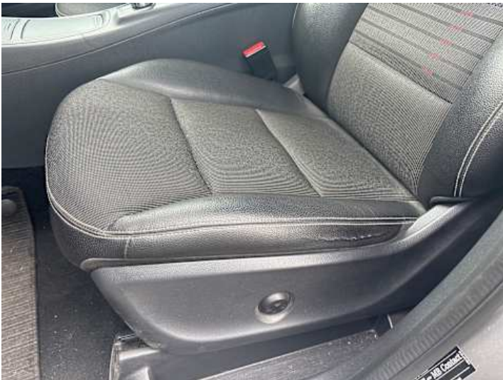
Innenraum (Riss/Bruch, Verschleiß)
