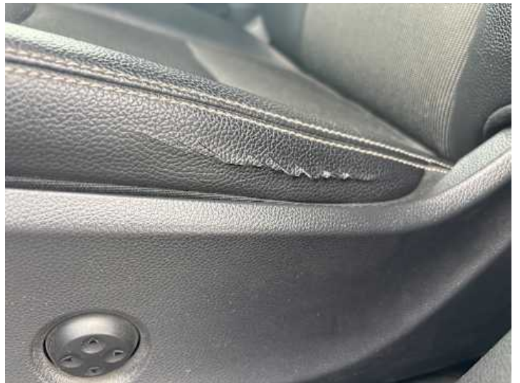
Innenraum (Riss/Bruch, Verschleiß)
