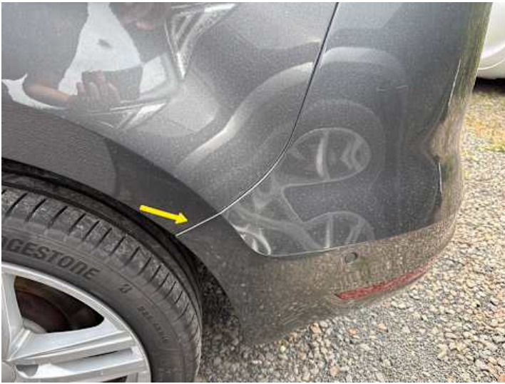
Stoßstange hinten (Unsachgemäß instand gesetzt)
