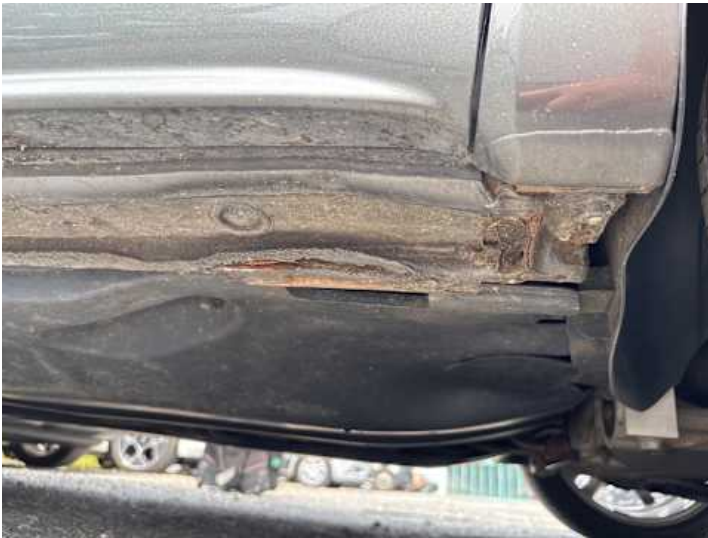
Schweller rechts (Verformung, Rost)
