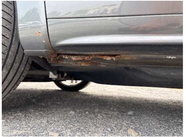
Schweller links (Verformung, Rost)
