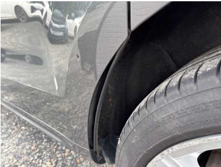
Seitenteil hinten links (Spaltmaße ungenau)
