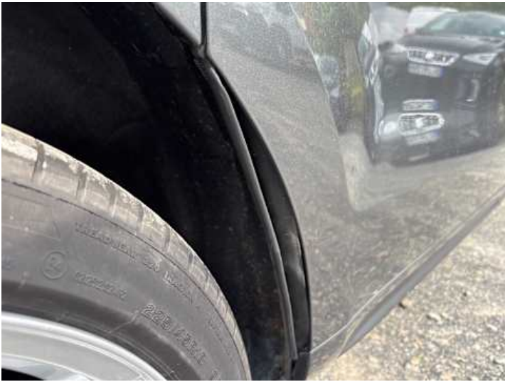
Seitenteil hinten rechts (Spaltmaße ungenau)
