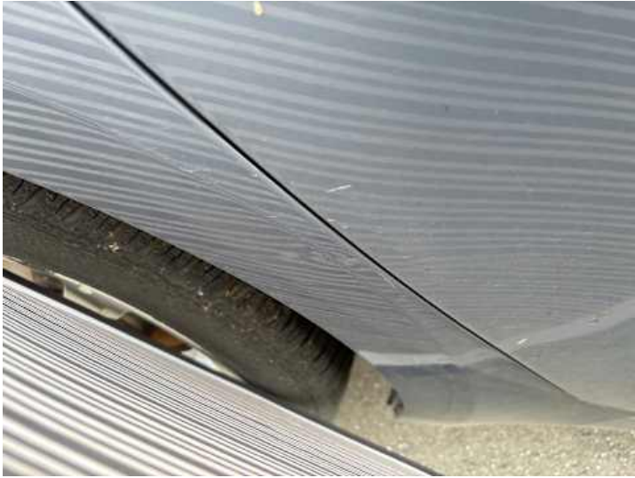
Seitenteil hinten rechts (Delle, Kratzer)
