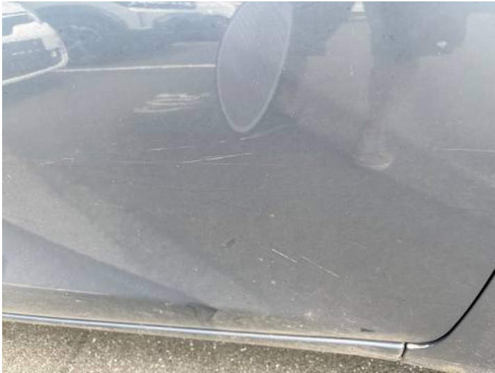
Beifahrtür (Kratzer, Verformung)
