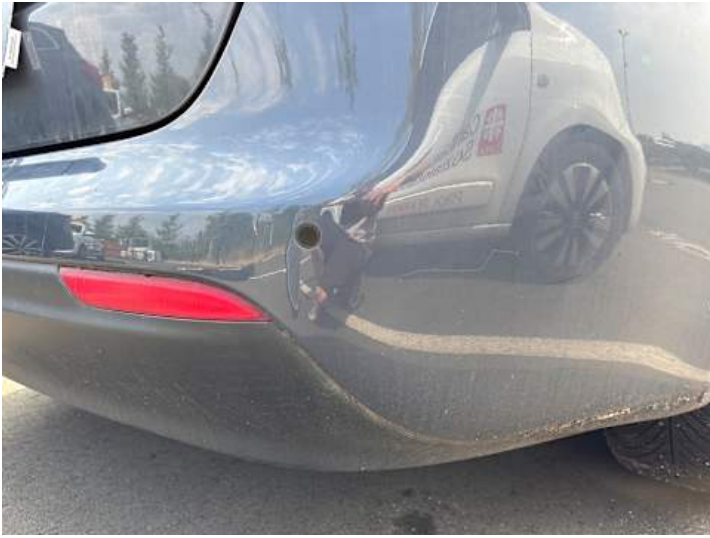
Stoßstange hinten (Kratzer)
