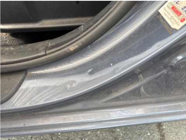
Schweller links (Delle, Kratzer)
