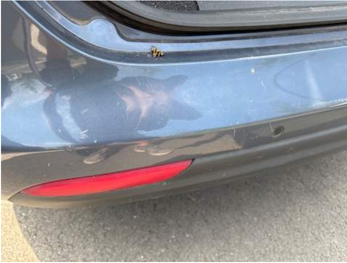
Stoßstange hinten (Kratzer)
