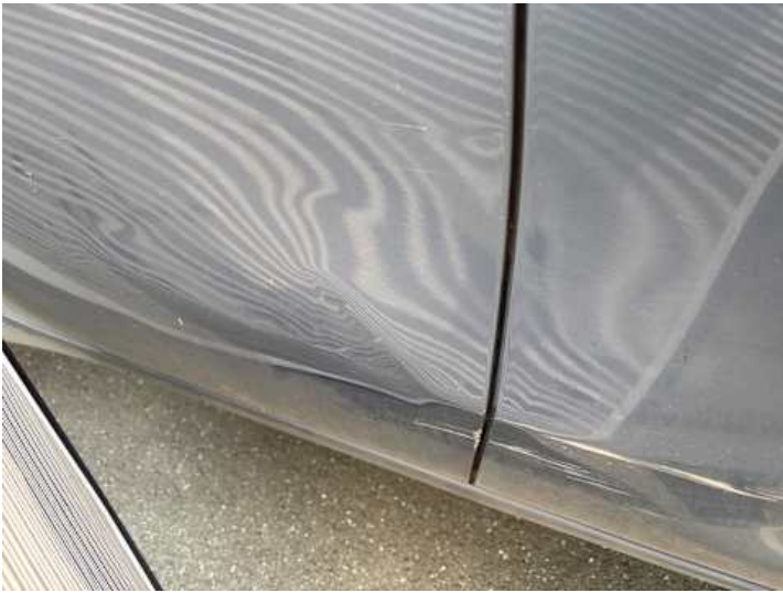
Türe hinten rechts (Kratzer, Verformung)
