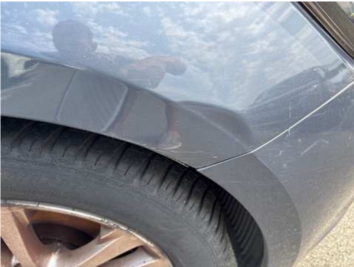
Kotflügel vorne rechts (Delle, Kratzer)
