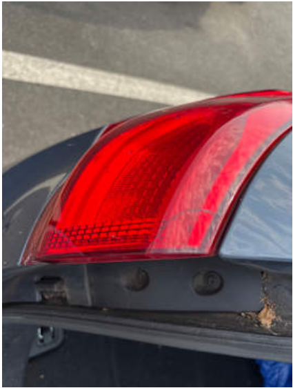
Rücklicht (links) (Riss/Bruch)
