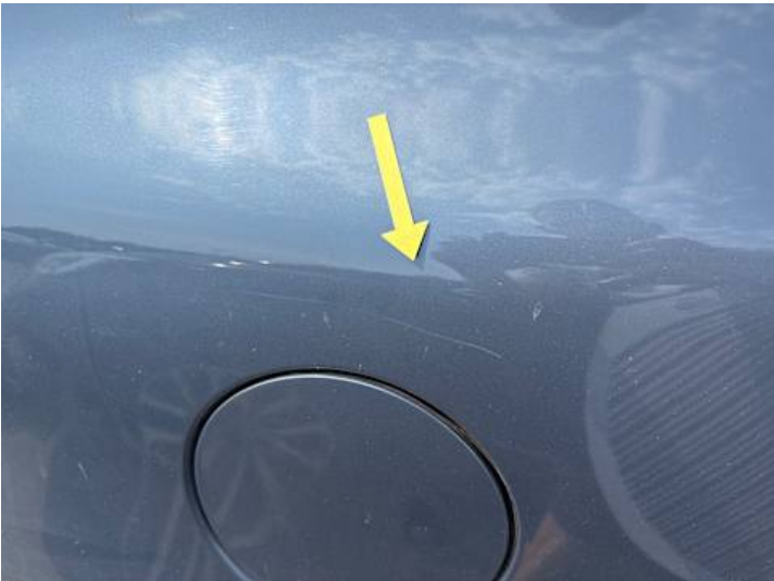
Seitenteil hinten links (Kratzer)
