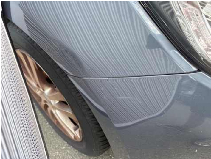
Kotflügel vorne rechts (Delle, Kratzer)
