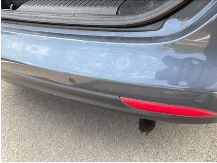
Stoßstange hinten (Kratzer)
