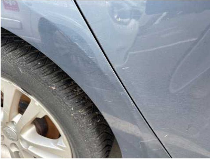
Seitenteil hinten rechts (Delle, Kratzer)
