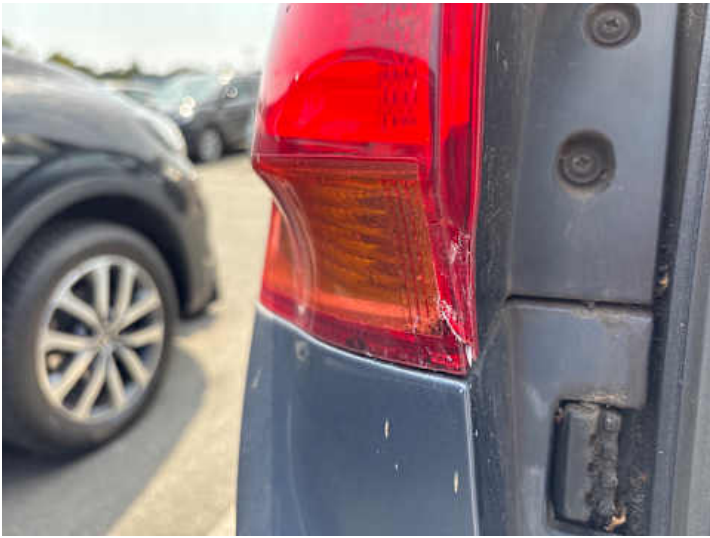
Rücklicht (links) (Riss/Bruch)
