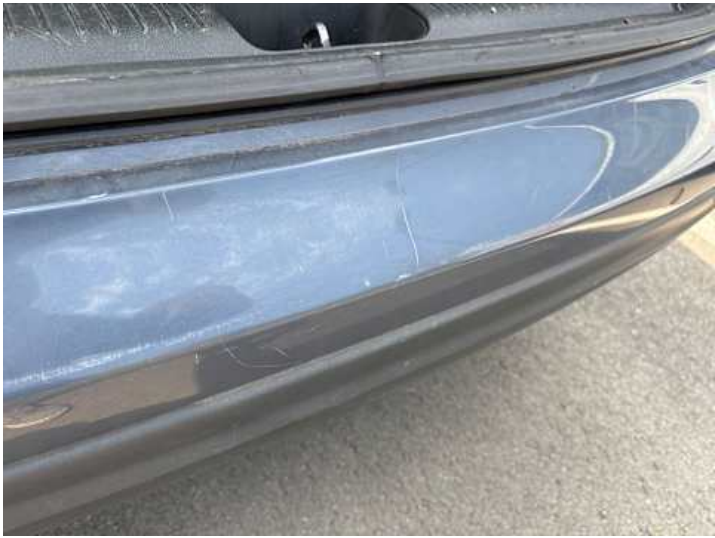
Stoßstange hinten (Kratzer)
