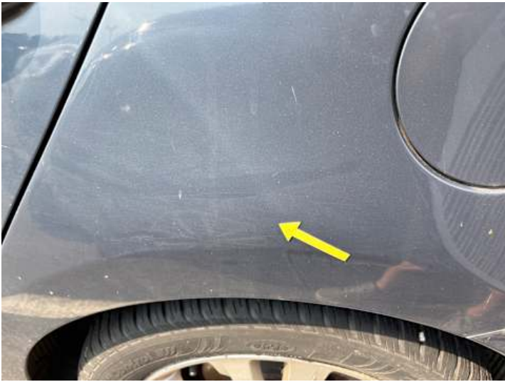
Seitenteil hinten links (Kratzer)
