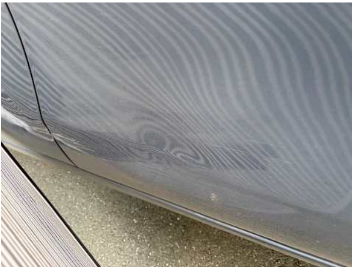
Beifahrertür (Kratzer, Verformung)
