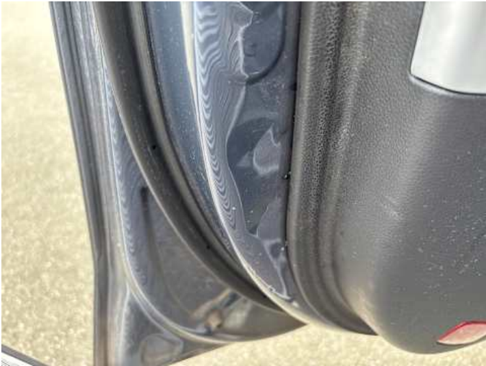
Fahrtür (Delle, Kratzer)
