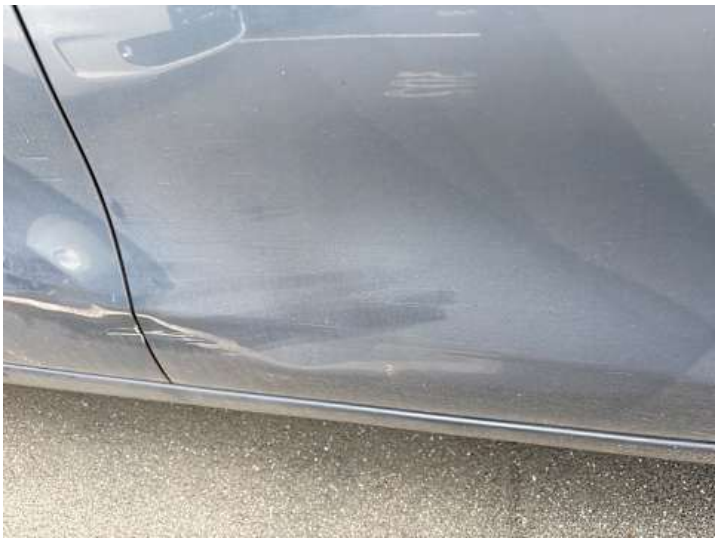
Beifahrertür (Kratzer, Verformung)
