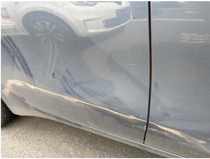
Türe hinten rechts (Kratzer, Verformung)
