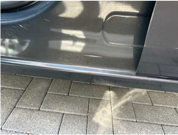
Schweller links (Kratzer)
