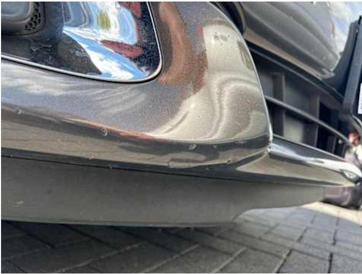
Stoßstange vorne (Kratzer, Verformung)
