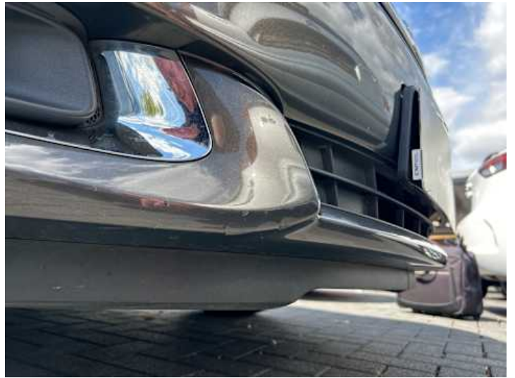
Stoßstange vorne (Kratzer, Verformung)
