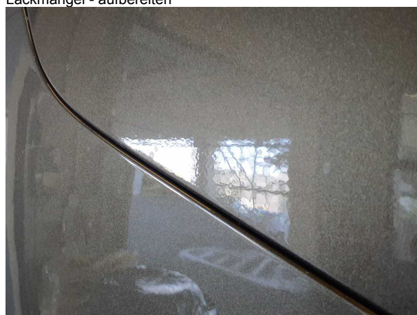
Beschädigung 3: Seitenwand rechts: Seitenwand - Lackmangel - aufbereiten
