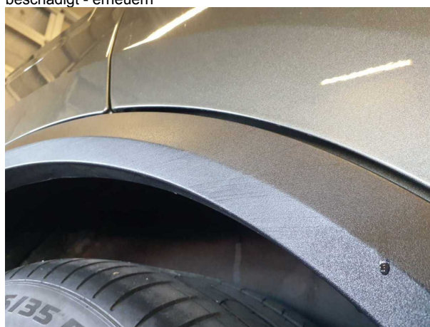
Beschädigung 5: Seitenwand rechts: Radhausverbreiterung - beschädigt - erneuern
