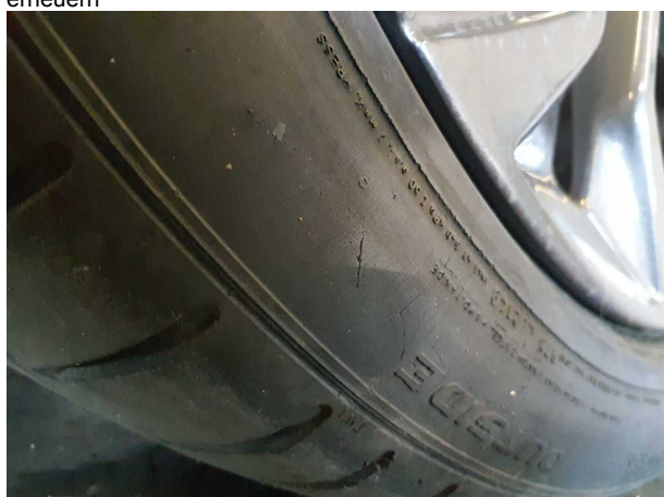
Beschädigung 6: Rad/Reifen: Reifen vorn rechts - beschädigt - erneuern
