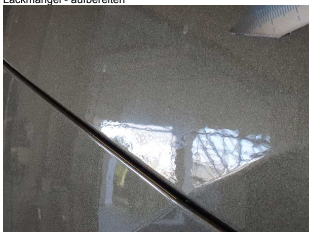
Beschädigung 3: Seitenwand rechts: Seitenwand - Lackmangel - aufbereiten
