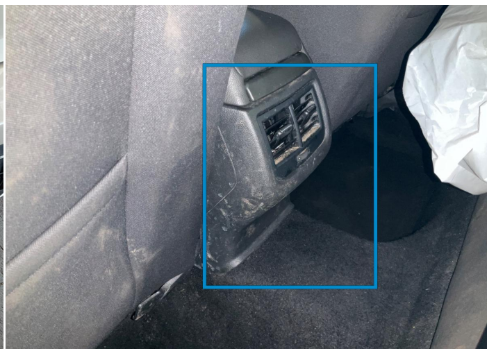
10. Belüftungsgitter / Hinten - Mitte Innen / Kratzer -
