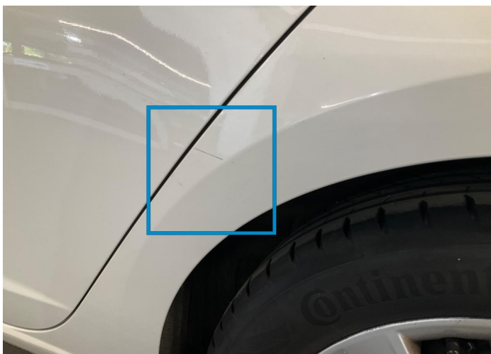
13. Kotflügel / Hinten Links Lack / Kratzer / Raster -
