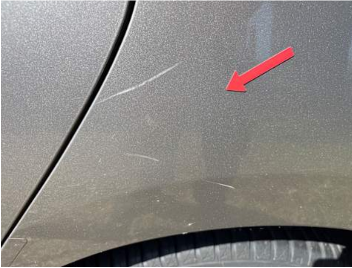
Seitenteil hinten links (Kratzer)
