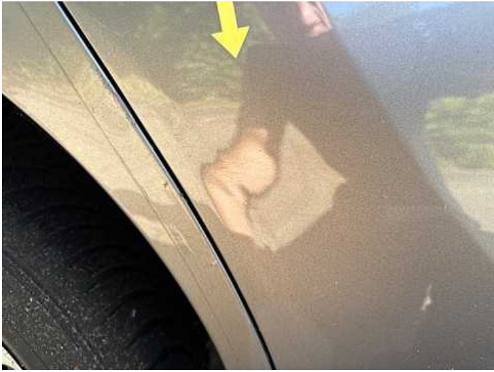
Türe hinten rechts (Verformung, Kratzer)
