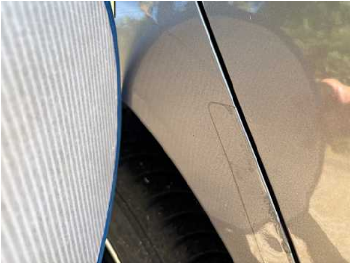
Seitenteil hinten rechts (Kratzer, Delle)
