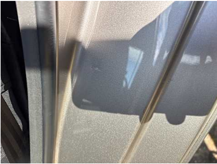
Seitenteil hinten links (Lackschaden, Delle)
