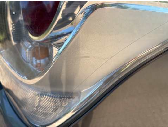
Rücklicht (rechts) (Kratzer)
