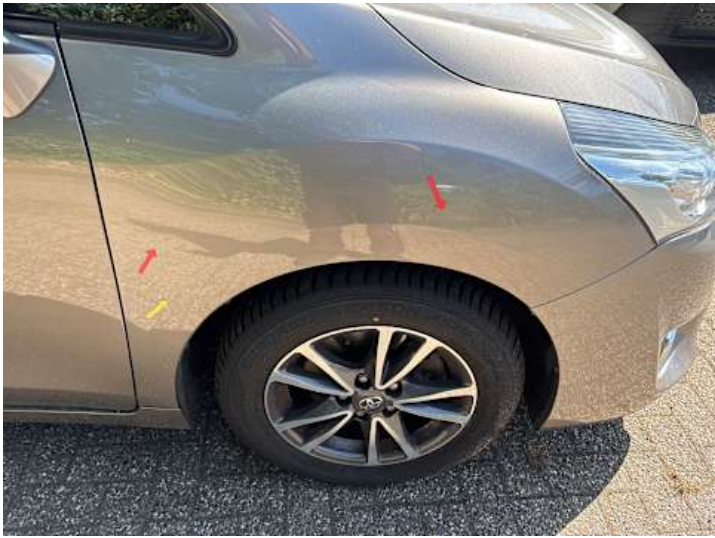
Kotflügel vorne rechts (Delle, Verformung)
