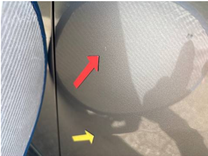
Kotflügel vorne rechts (Delle, Verformung)
