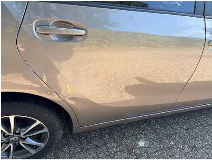
Türe hinten rechts (Verformung, Kratzer)
