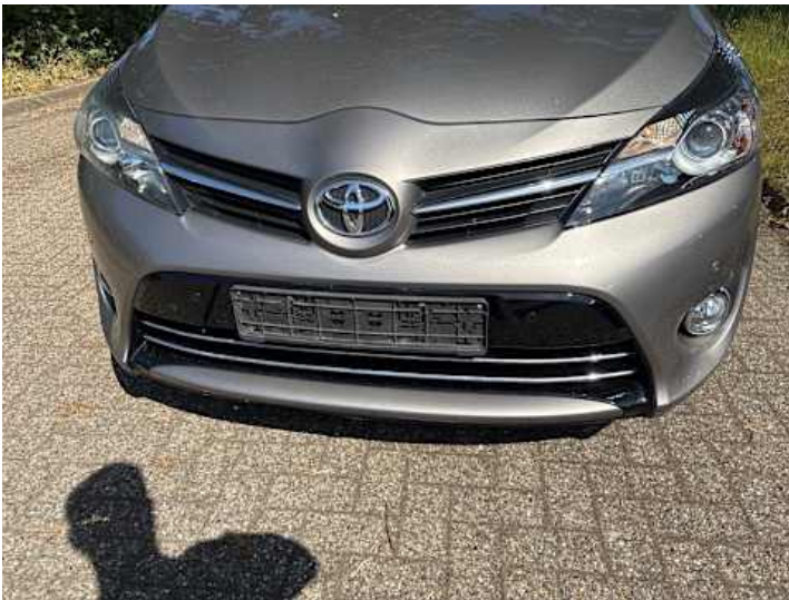
Stoßstange vorne (Lackschaden, Kratzer, Riss/Bruch)
