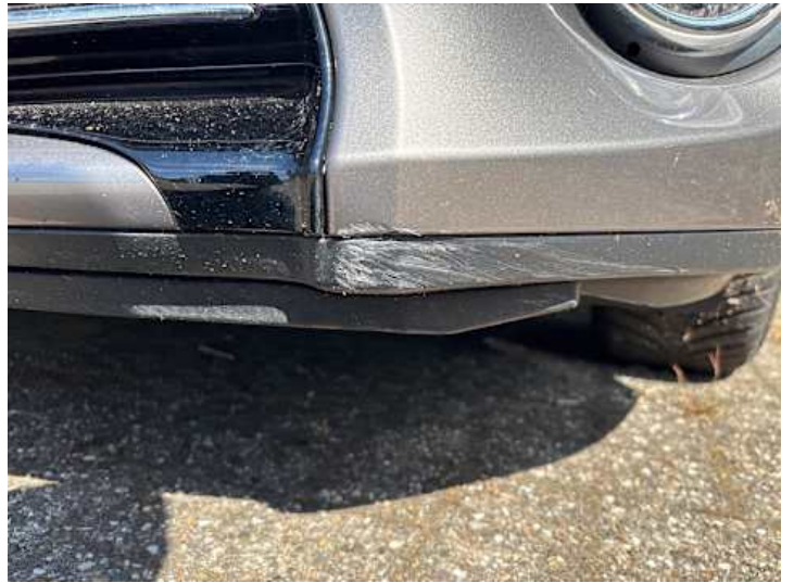
Stoßstange vorne (Lackschaden, Kratzer, Riss/Bruch)
