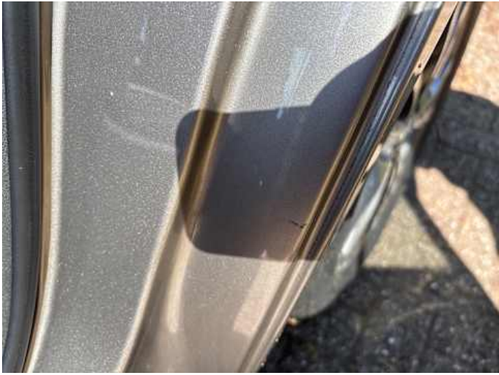
Seitenteil hinten links (Lackschaden, Delle)
