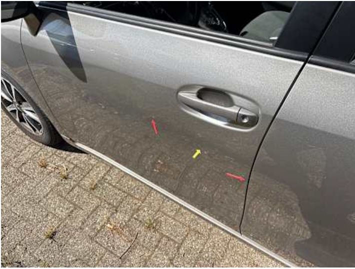
Fahrtür (Lackschaden, Kratzer)
