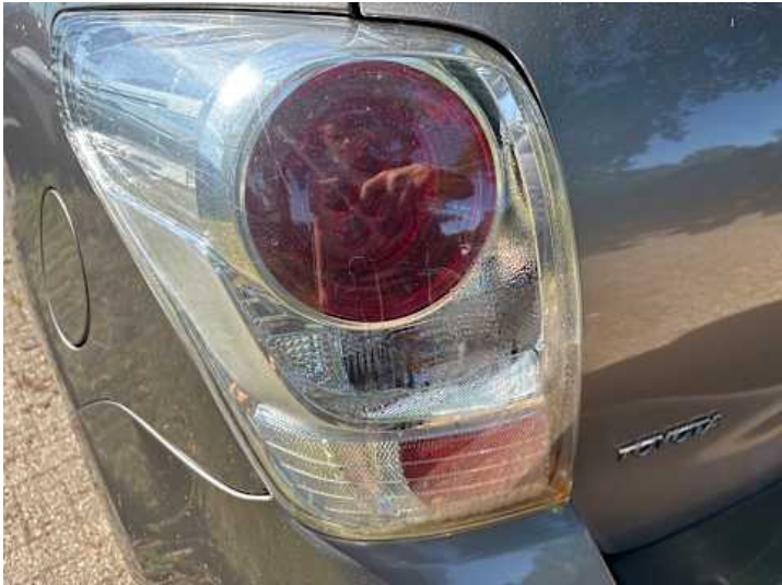
Rücklicht (links) (Undicht, Kratzer)
