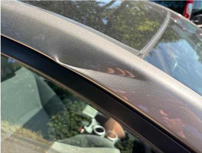
Dach (Verformung, Lackschaden)
