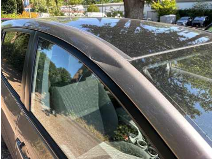
Dach (Verformung, Lackschaden)
