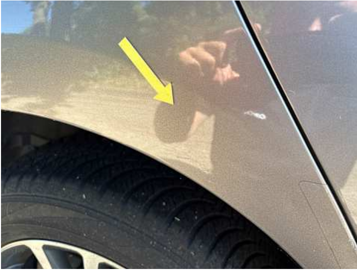
Seitenteil hinten rechts (Kratzer, Delle)
