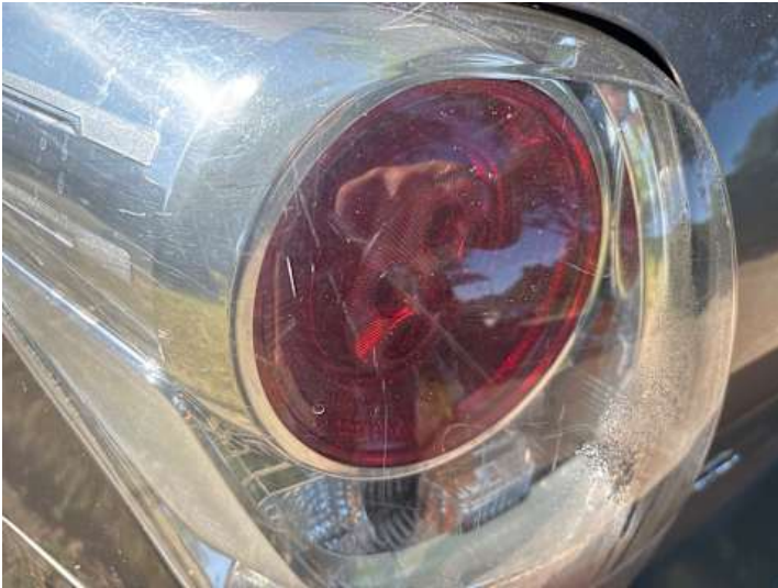
Rücklicht (links) (Undicht, Kratzer)
