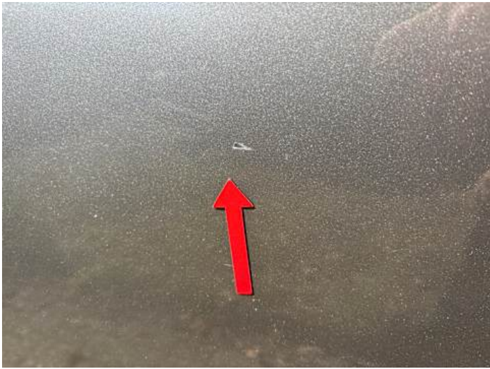
Fahrtür (Lackschaden, Kratzer)
