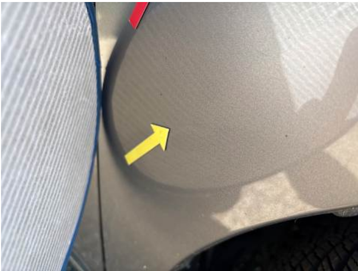
Kotflügel vorne rechts (Delle, Verformung)
