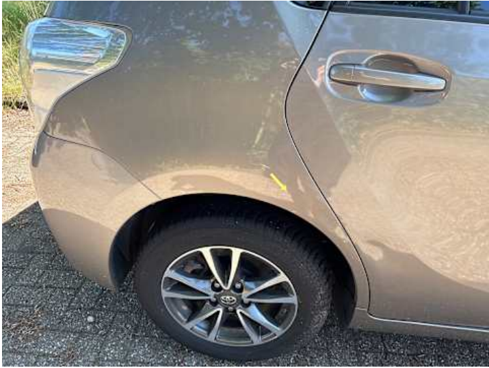
Seitenteil hinten rechts (Kratzer, Delle)
