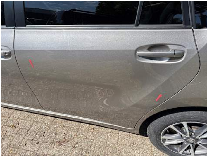
Türe hinten links (Kratzer)
