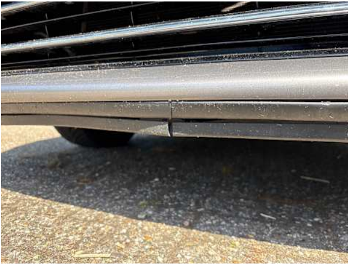
Stoßstange vorne (Lackschaden, Kratzer, Riss/Bruch)
