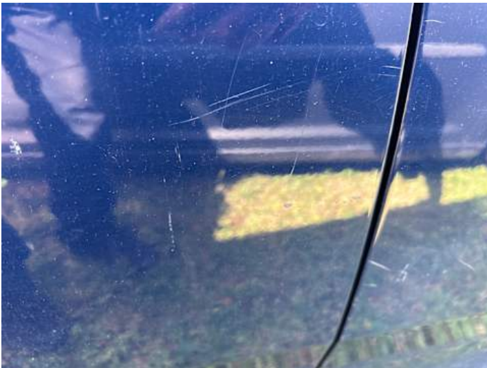
Türe hinten rechts (Kratzer, Lackschaden)
