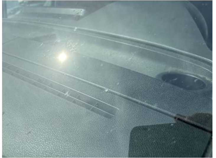
Windschutzscheibe (Steinschlag, Riss/Bruch)
