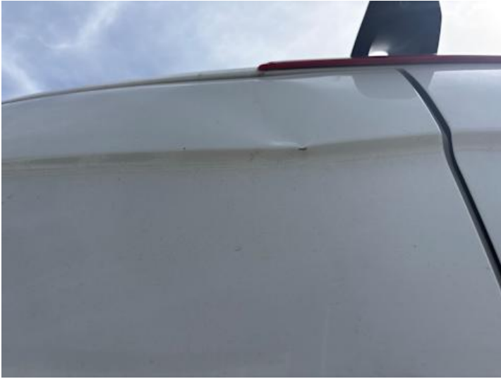
Heckklappe (Verformung, Kratzer)
