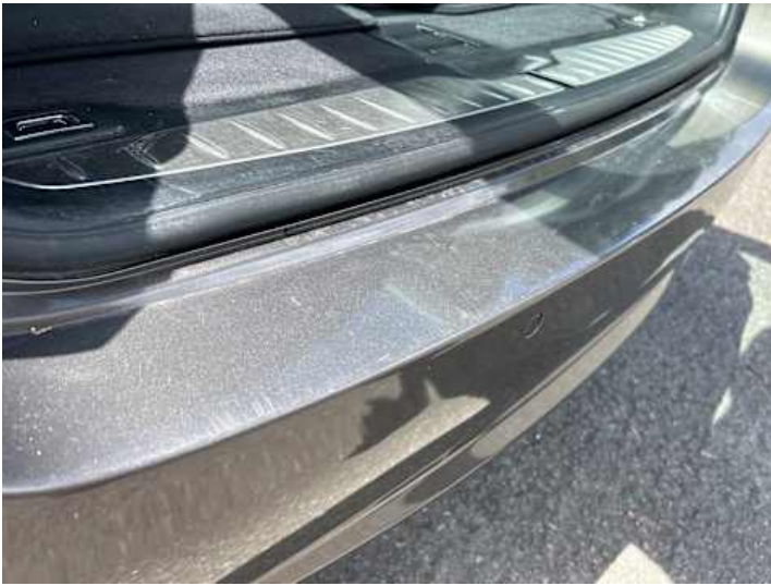
Stoßstange hinten (Kratzer, Lackschaden)
