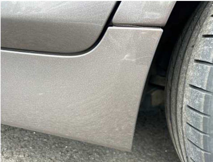
Schweller links (Kratzer)
