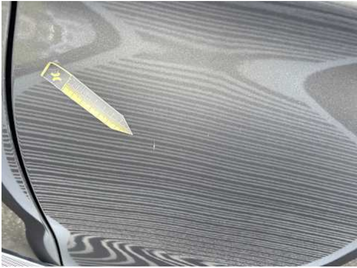
Türe hinten links (Delle, Kratzer)
