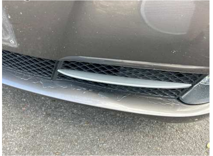
Stoßstange vorne (Lackschaden)
