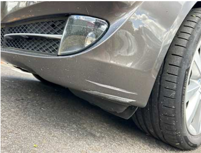
Stoßstange vorne (Kratzer, Lackschaden)
