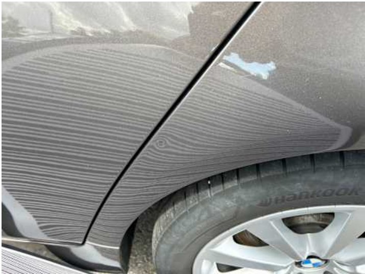
Seitenteil hinten links (Delle)
