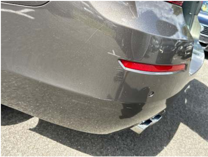
Stoßstange hinten (Kratzer, Lackschaden)
