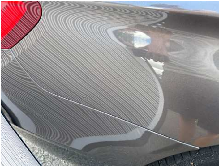
Seitenteil hinten rechts (Delle)
