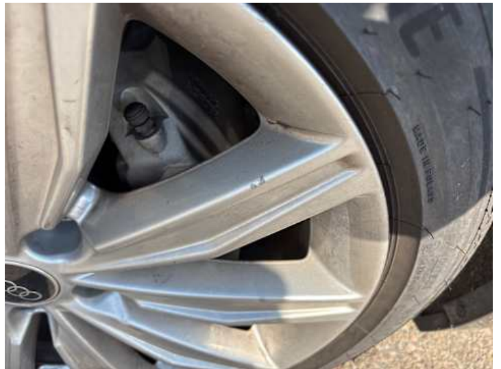
Rad (Anderer Schaden): Lackschäden
