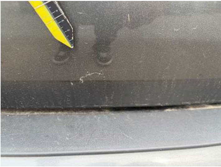
Heckklappe (Lackschaden, Kratzer)
