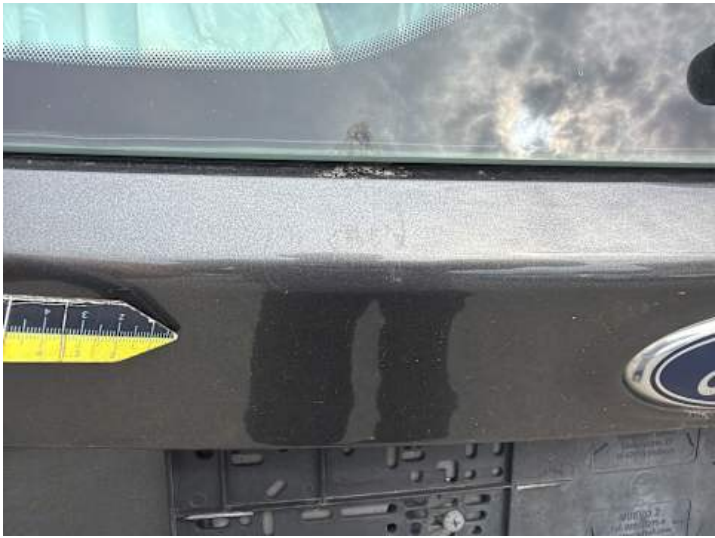
Heckklappe (Lackschaden, Kratzer)
