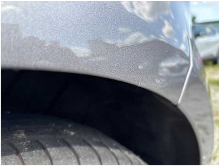
Seitenteil hinten links (Lackschaden)
