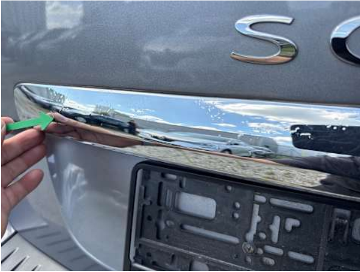
Heckklappe (Anderer Schaden): Ablösungen
