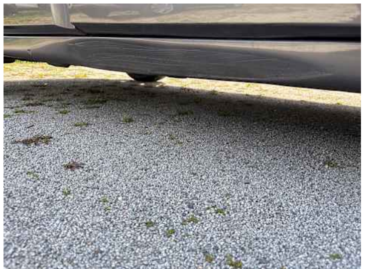
Schweller rechts (Verformung, Kratzer, Delle)
