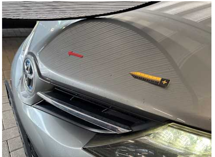
Motorhaube (Delle, Steinschlag, Rost)
