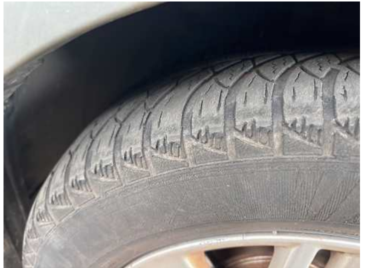
Rad (Ungleichmäßig abgefahren)
