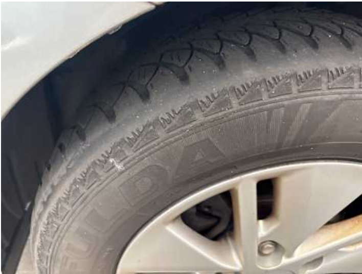
Rad (Ungleichmäßig abgefahren)
