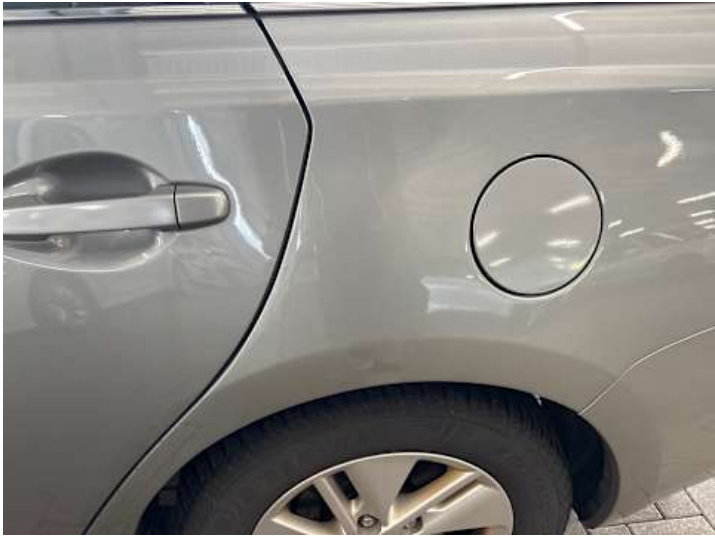
Seitenteil hinten links (Lackschaden)
