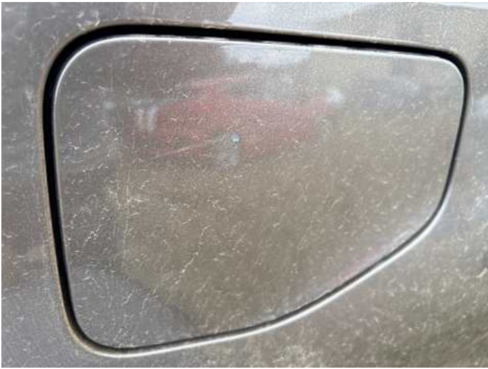
Seitenteil hinten rechts (Kratzer)
