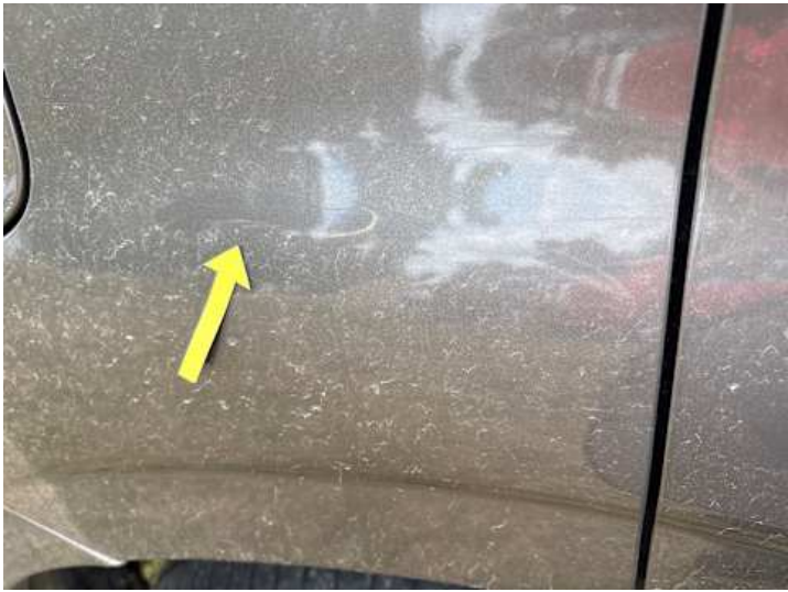
Seitenteil hinten rechts (Kratzer)
