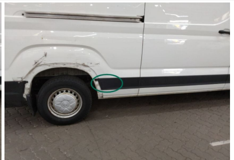
Zierleiste Seitenwand / Hinten Rechts / Kratzer
