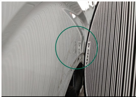
Seitenwand / Unten Hinten Rechts / Delle
