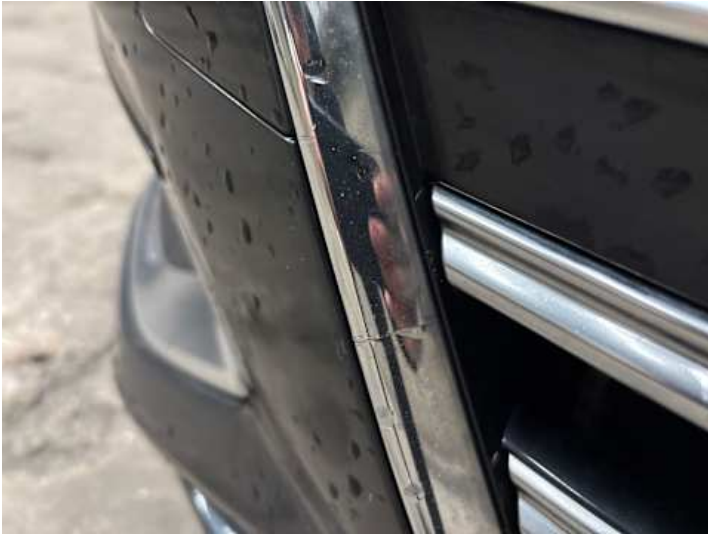
Stoßstange vorne (Riss/Bruch)
